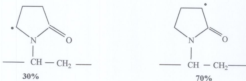
FIGURA 4 - Estrutura dos radicais de PVP produzidos por radiação ionizante [33].
