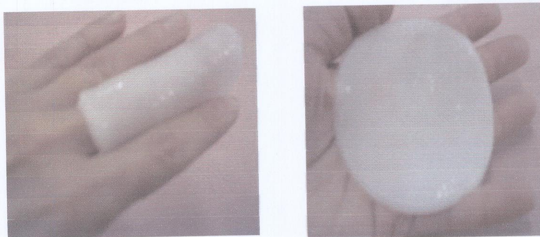
FIGURA 38 - Membranas de hidrogéis PVAI obtidas por reticulação térmica variando-se a concentração de PEG.
