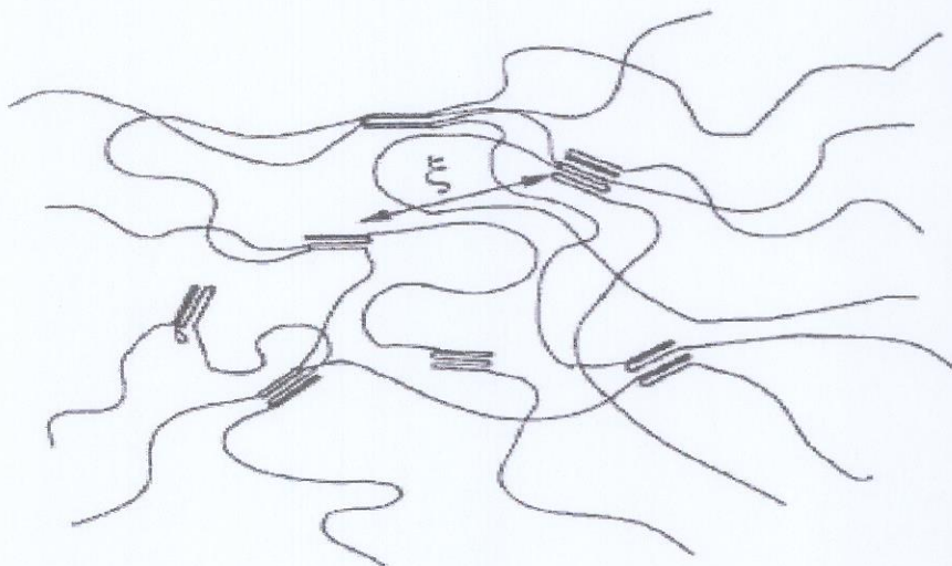
FIGURA 9 – A estrutura tri-dimensional reticulada do hidrogel obtida por ciclos térmicos [28], representação dos cristalitos.
