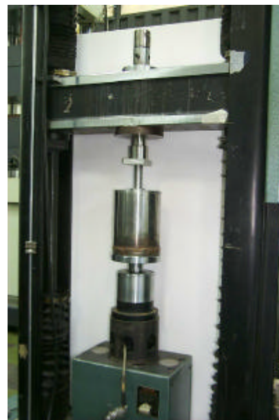
Figura 6. Montagem da câmara na máquina universal.
