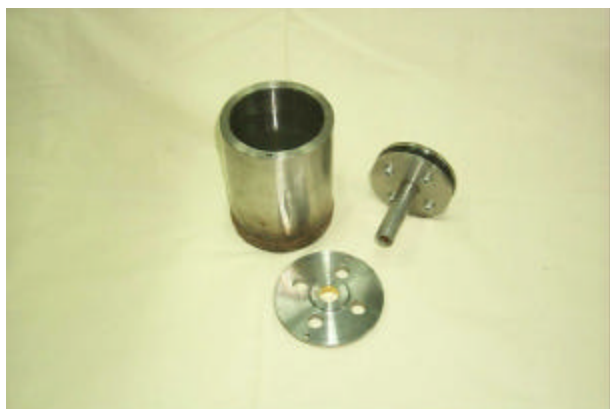
Figura 5. Câmara de pressão usada no ensaio hidrostático
