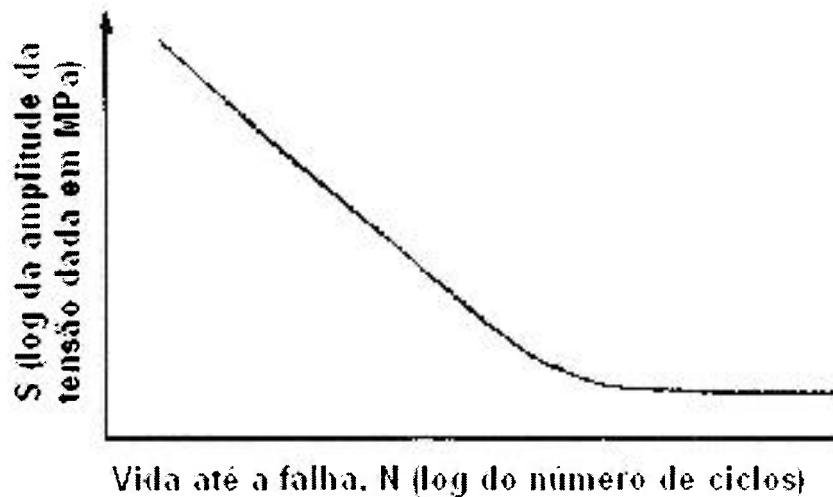
FIGURA 3-7 - Curva S-N típica em escala log-log
