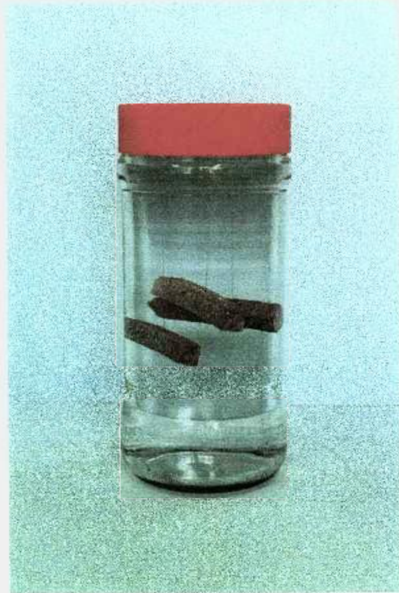
Figura 4.5: Amostras prismáticas imersas em solução de sulfato de sódio.
