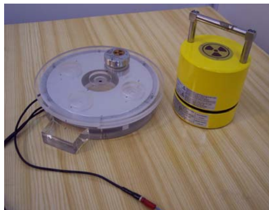
Figura 3. Câmara anelar com a fonte de controle de 90 Sr+ 90 Y disposta na posição 1 do suporte para fonte.
