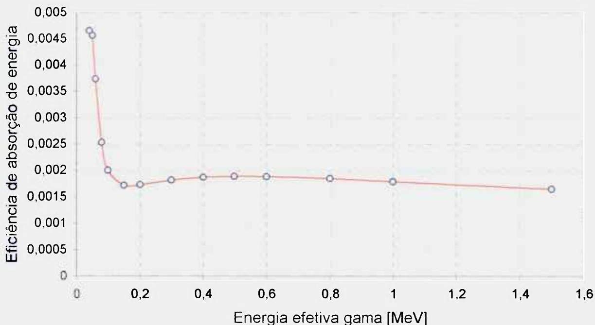
Figura 4.4 : Eficiência de absorção de energia para o dosímetro posicionado sob o filtro de 0,3 mm de cobre.
