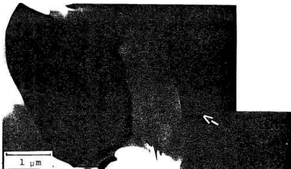
Figura 4.34. Micrografia obtida por campo claro do material de composição BC-04, prensado a quente nas condições 20 MPa/2073K/1h, MET. Difração eletrônica da fase boro metálico \vec{B} = |2,0,1|
