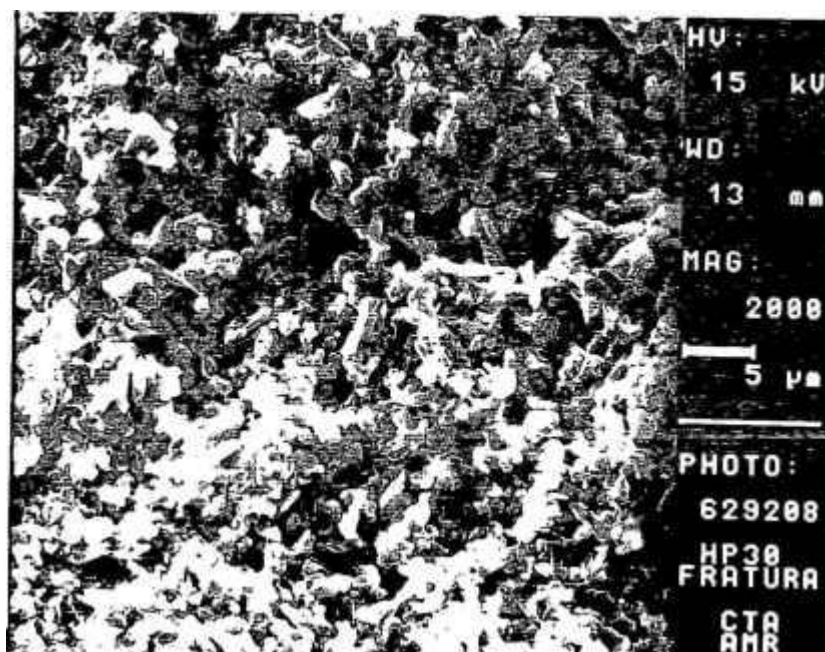
Figura 4.16. Superfície de fratura do material prensado a quente nas condições de 1973K/60min/20MPa MEV.
