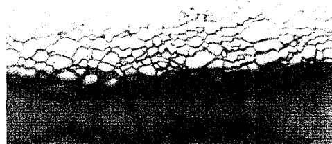
FIGURA 3.8b - Oxidação do UO_2 progredindo ao longo dos contornos de grãos causando a separação de grãos da matriz da pastilha (Lewis et al., 1992)
