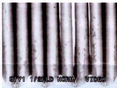
FIGURA 5.3b - EC G21 (face sul, acima da GR2). Deposição de cruds nas VC 116 a B16 (Tecnatom, 1997)
