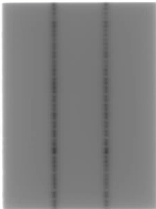
Figura 13 – Teste de MLC. Representação do teste 3ABUT. 3 Segmentos de 6 cm por 24 cm irradiados sequencialmente para se avaliar as regiões de encontro dos feixes.
