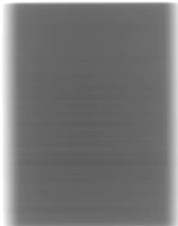
Figura 14 – Testes de MLC. Representação do teste DMLC1. Um retângulo de 2 cm por 20 cm varre da posição -10 cm até +10 cm com velocidade constante enquanto o feixe de radiação entrega dose a uma taxa constante.
