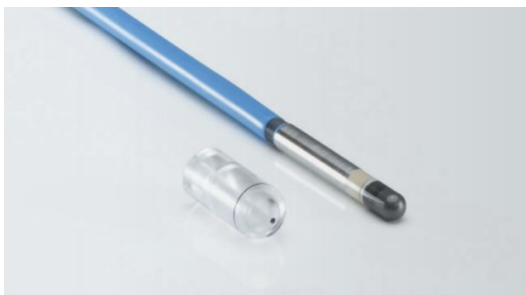
Figura 18 – CI PTW semiflex de 0,125\text{cm}^3 (7)
