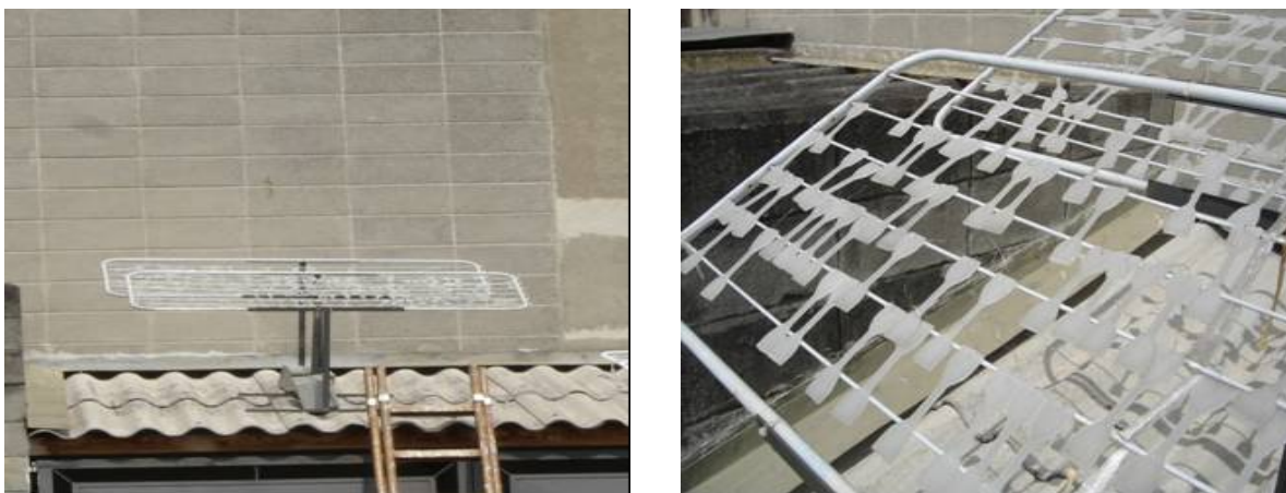
Fig. 1 – Amostras montadas em um dispositivo para ensaio de envelhecimento natural, confeccionado no laboratório de polímeros do IPEN-CQMA.
