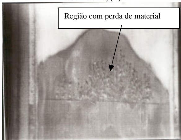
Figura 10. Oxidação e Erosão na Região da Junção da Lâmina de Ag-In-Cd com o Prolongador de Ni. (Vide Fig. 1). (BS1- Face Interna Da Lâmina 2) [2].
