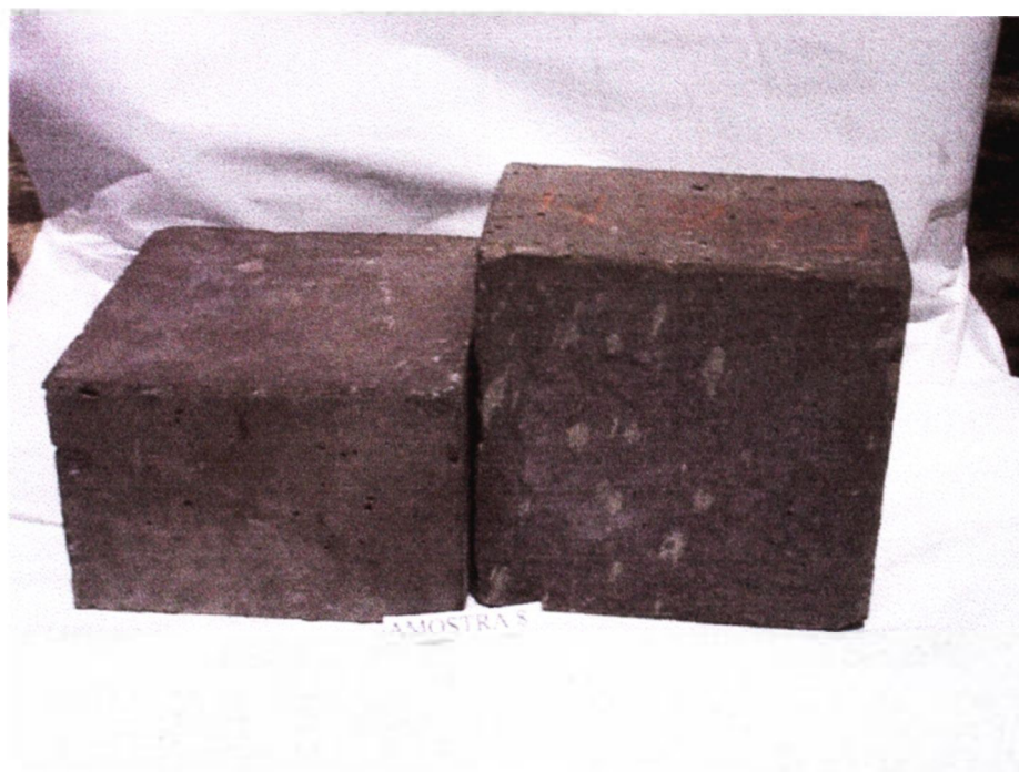
Figura 14: Corpos-de-prova de concreto, prismáticos, para ensaios de blindagem.
