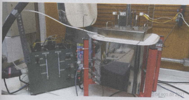
34 Arranjo experimental de operação de SOFC unitária de etanol direto, desenvolvido no IPEN. Crédito: Foto de Francisco Nobuo Tabuti.
