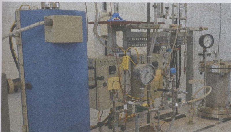
27 Sistema experimental com reator de reforma catalítica a vapor do etanol. Fonte: Acervo do IPEN.
