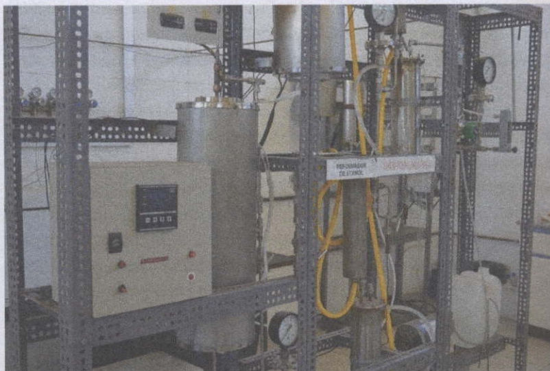
30 Sistema de reforma do etanol com reator de membrana de Pd. Fonte: Acervo do IPEN.
