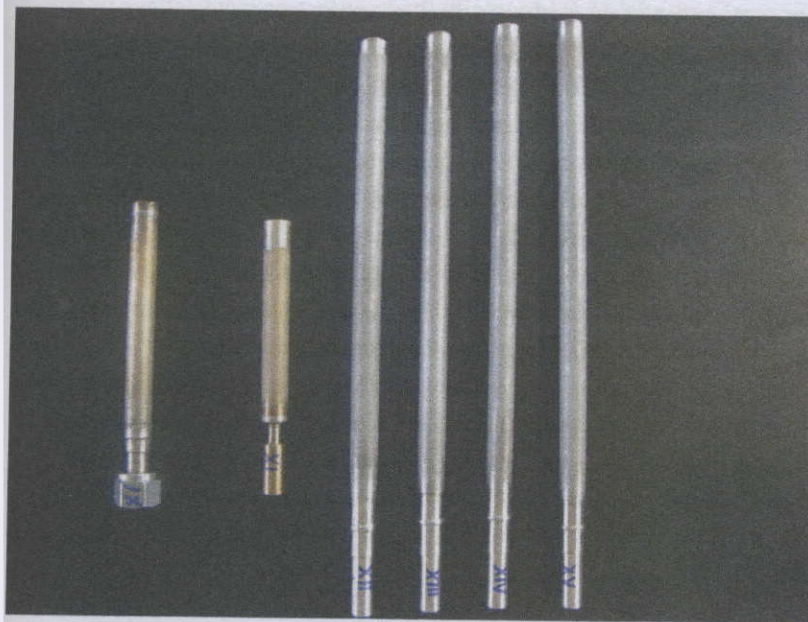
31 Reactores a membranas de Pd/Ag sobre aço inox AccuSep desenvolvidas no IPEN, soldadas às respectivas junções. Fonte: Acervo do IPEN.
