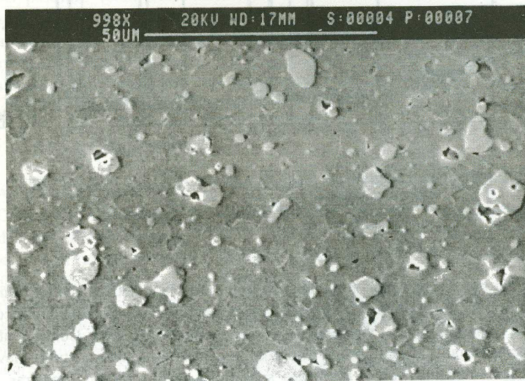
Figura 3 - Amostra \text{Al}_2\text{O}_3 - 40 % em massa de NbC sinterizada a 1650 °C, atacada quimicamente.
