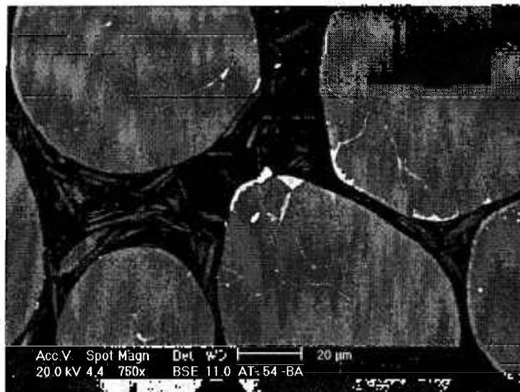
FIGURA 4.15 - Micrografia eletrônica da amostra de SiGQ AT54BA (atomizada), obtida por MEV utilizando-se imagem de elétrons retroespalhados.
