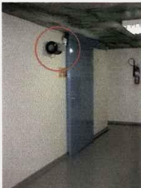
Figura 3.12: Detector de nêutron modelo 942A fixado na parede das dependências X e XII
