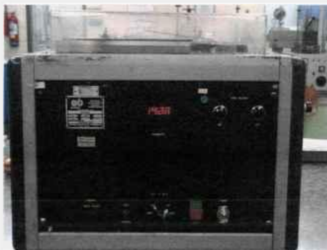
Figura 3.15 – Medição de Rigidez Dielétrica, com corte automático na tensão de ruptura, expressa em KV
