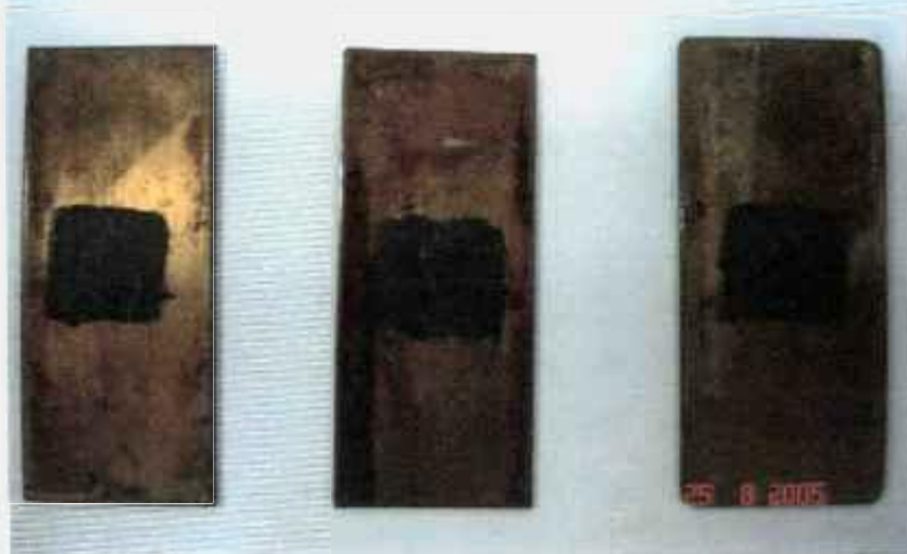
Figura 3.8 - Eletrodos de cobre com grafite coloidal aplicado para a medida de tanelta.
