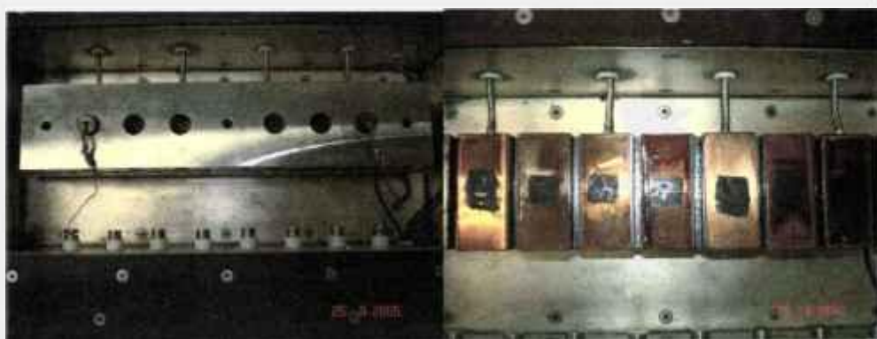
Figura 3.7 - Montagem experimental do suporte de medição no equipamento e disposição dos eletrodos no mesmo.
