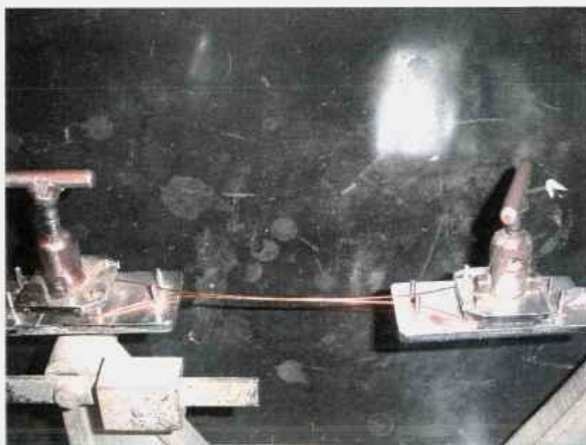
Figura 3.10 – Montagem do par trançado
