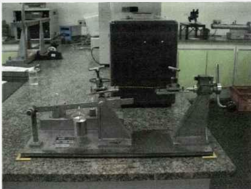
Figura 3.9 – Equipamento para a torção de fios magnetos destinados teste de vida térmica
