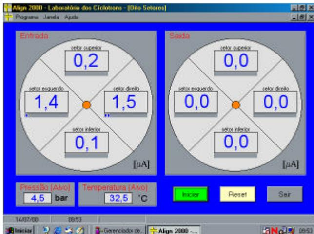
Figura 3. Tela de Controle dos quatro setores, pressão e temperatura
