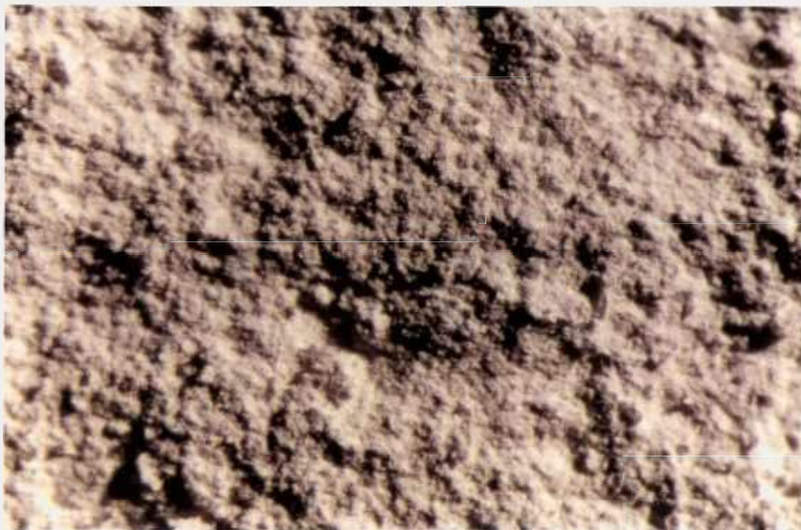
FIGURA IV.6.a - Superfície de Fratura. Corpo Verde Prensado Uniaxialmente a 150 MPa. Aumento 25 vezes.
