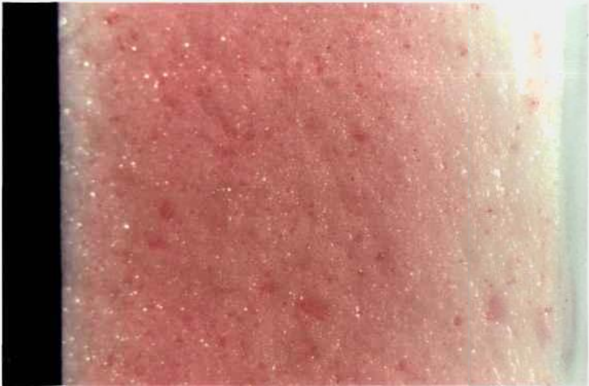
FIGURA IV.9.a - Superfície de Fratura. Corpo Sinterizado, prensado Uniaxialmente a 150 MPa. Aumento 18 vezes.
