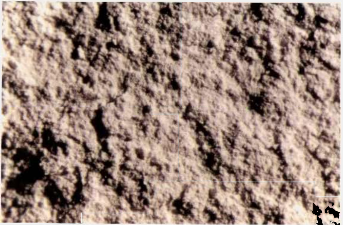
FIGURA IV.7.a - Superfície de Fratura. Corpo Verde Prensado Isostaticamente a 200 MPa. Aumento 25 vezes.
