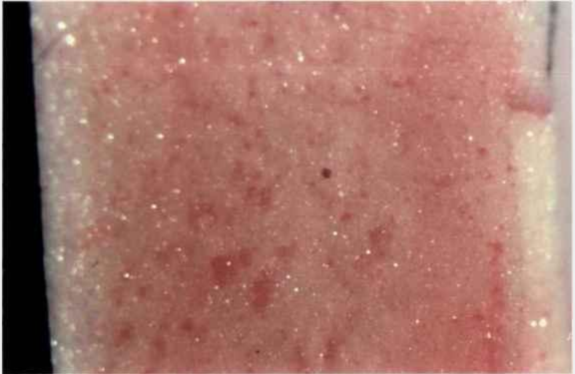
FIGURA IV.10.a - Superfície de Fratura. Corpo Sinterizado, Prensado Isostaticamente a 200 MPa. Aumento 18 vezes.
