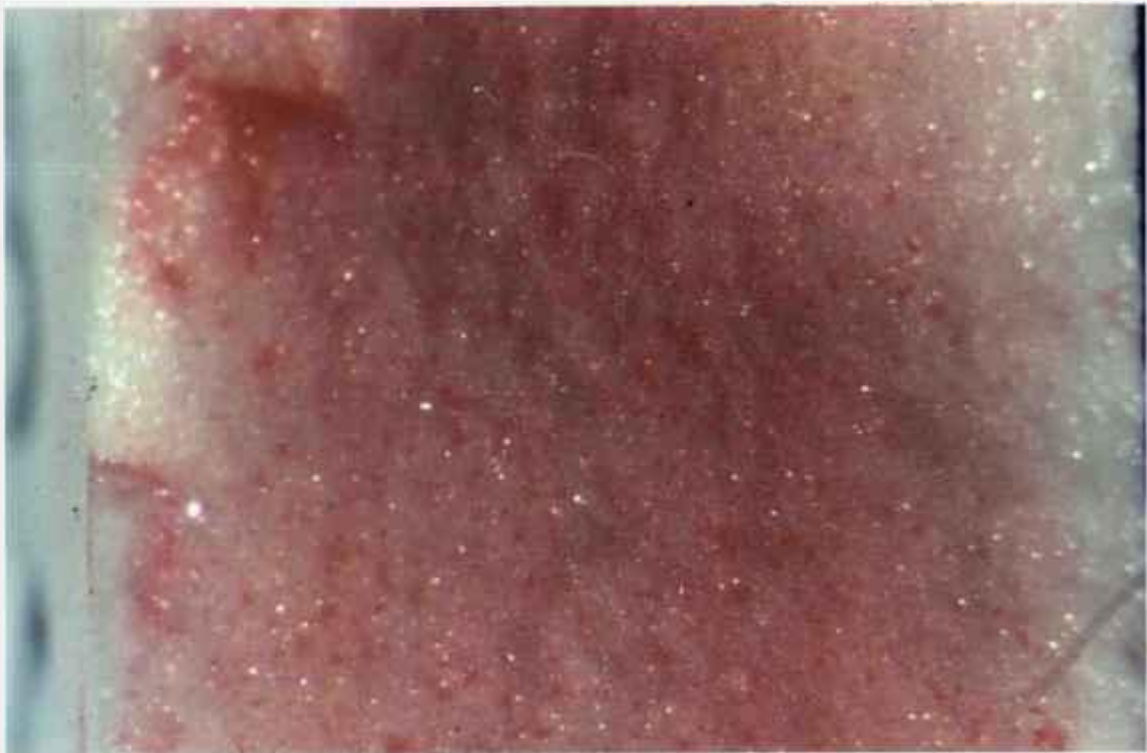
FIGURA IV.11.a - Superfície de Fratura. Corpo Sinterizado, Prensado Uniaxialmente a 15 MPa e Isostaticamente a 200 MPa. Aumento 18 vezes.
