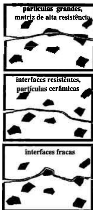
Figura II.3.4.1- Mecanismos de fraturas que os CMM reforçados por partículas podem apresentar.(1)
