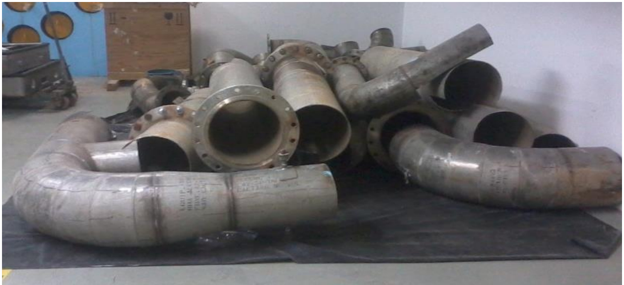
1 Figura 1: Dutos do circuito primário do sistema de refrigeração, substituídos durante manutenção do reator CERPq, em 2014.
