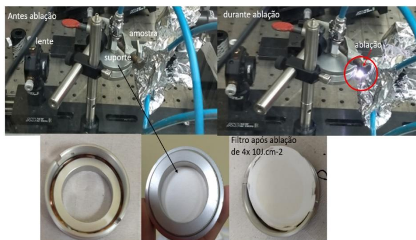
Figura 25: Arranjo ablação com filtro.
