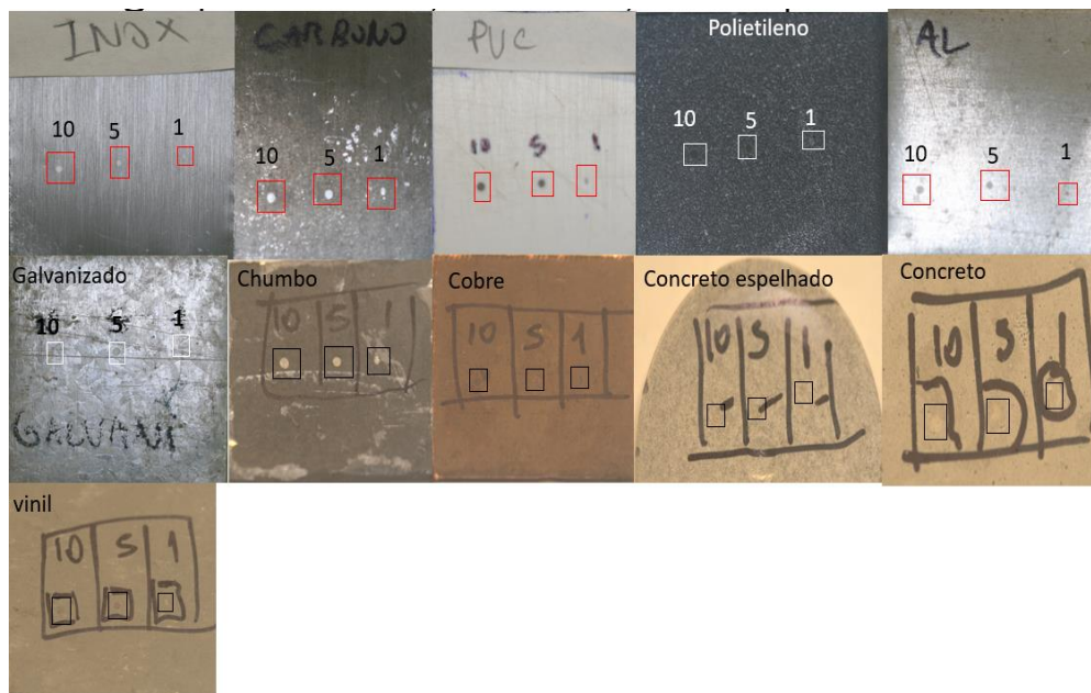
Figura 14: Imagens dos 10 materiais (inox, carbono, galvanizado, alumínio, PVC, concretos, cobre, chumbo, vinil e polietileno) que foram ablaçionados com um pulso único para as fluências de (10, 5 e 1) J.cm -2 .
