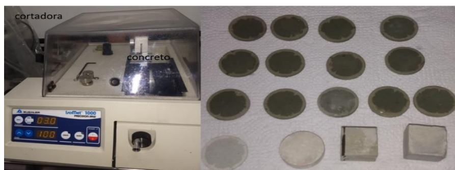
Figura 10: Cortadora metalográfica (esquerda) e placas de concreto (diâmetro: 2,5 cm, espessura: 3 mm).
