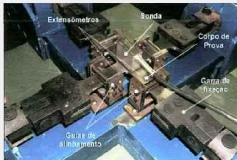
FIGURA 3.11. Dispositivo para a aplicação de esforços biaxiais no corpo de prova cruciforme.
