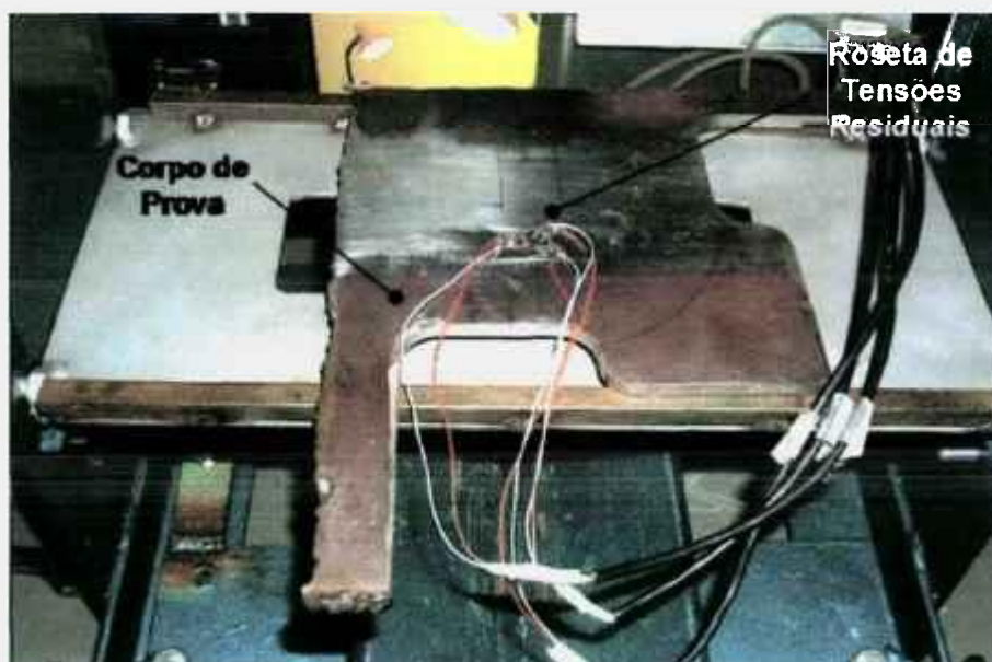
FIGURA 3.16. Roseta para ensaio de tensões residuais pelo Método do Furo Central.
