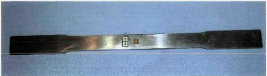
FIGURA 3.9. Corpo de Prova para estudos de deformação sob carregamentos de tração.
