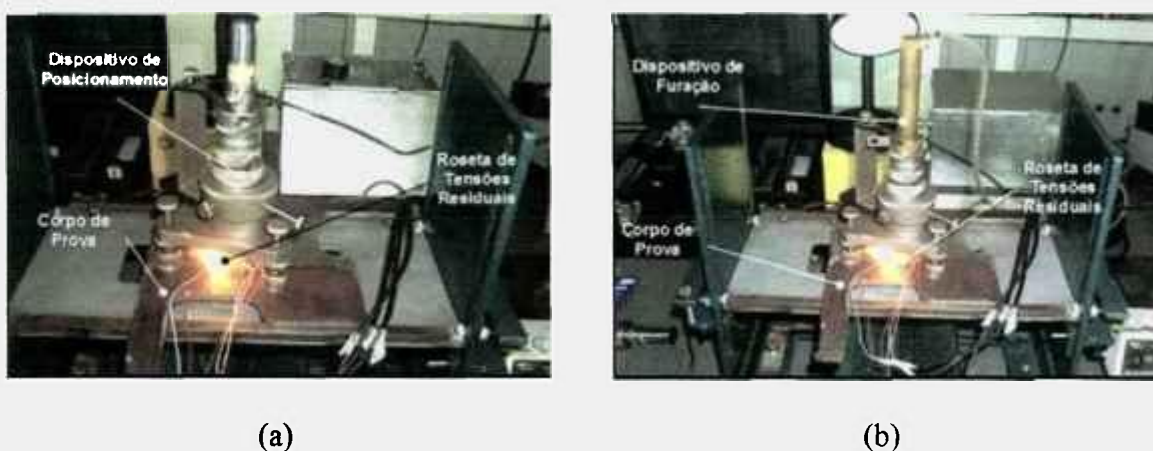
FIGURA 3.15. Dispositivo de precisão composto por (microscópio para posicionamento da ferramenta na roseta) (a) e (ferramenta de furação) (b).
