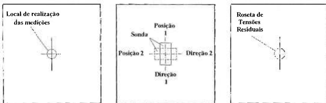
FIGURA 4.177 – Local e posicionamento da sonda e roseta para medições de tensões residuais.
