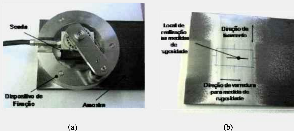
FIGURA 3.20 - Posicionamento da sonda magnetoelástica para a medição do ruído magnético Barkhausen (a), direção de lixamento e de medição da rugosidade superficial da amostra (b).
