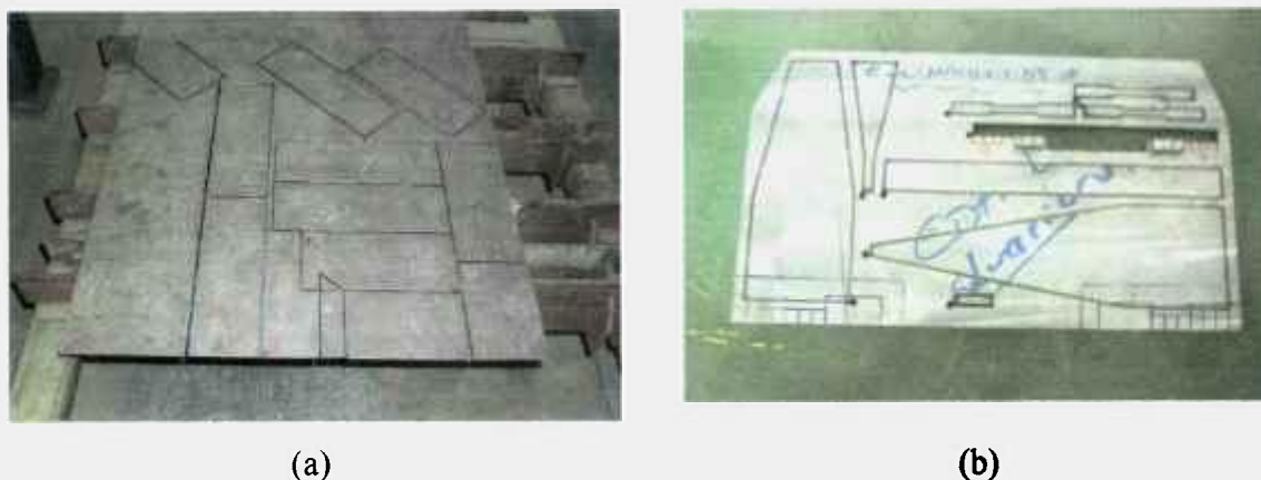
FIGURA 3.3. Corte das chapas para retirada de amostras para fabricação de corpos de prova para os aços ASTM A 36, A 515 e USI SAC 50 (a) e 20 MnMoNi55 (b).
