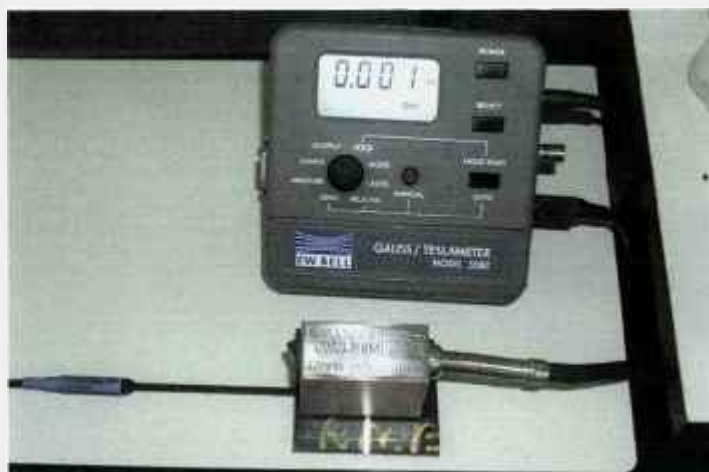
FIGURA 3.17 – Montagem experimental utilizada para determinar o valor do campo magnético produzido nas extremidades do núcleo ferromagnético da sonda magnetoelástica.
