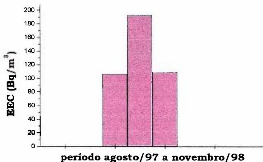
Fig. 4.5: Concentração equivalente em equilíbrio de torônio ( $\text{Bq}/\text{m}^3$ ) na fase de operação (2) da unidade de purificação de tório (dados da tabela 4.3)
