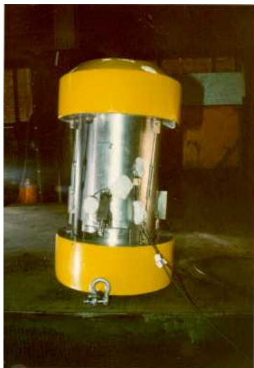
Figura 2. Embalagem GNS após teste de queda-livre de 9m (os amortecedores são os componentes de cor amarela).
