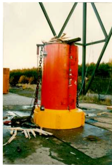
Figura 3. Embalagem TRANSNUCLEAR após teste de queda livre.
