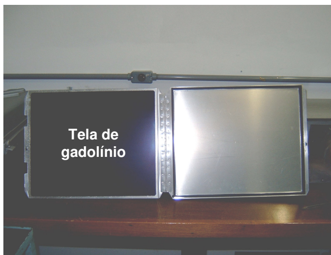
FIGURA 2.1- Cassete de alumínio com tela conversora de gadolínio.
