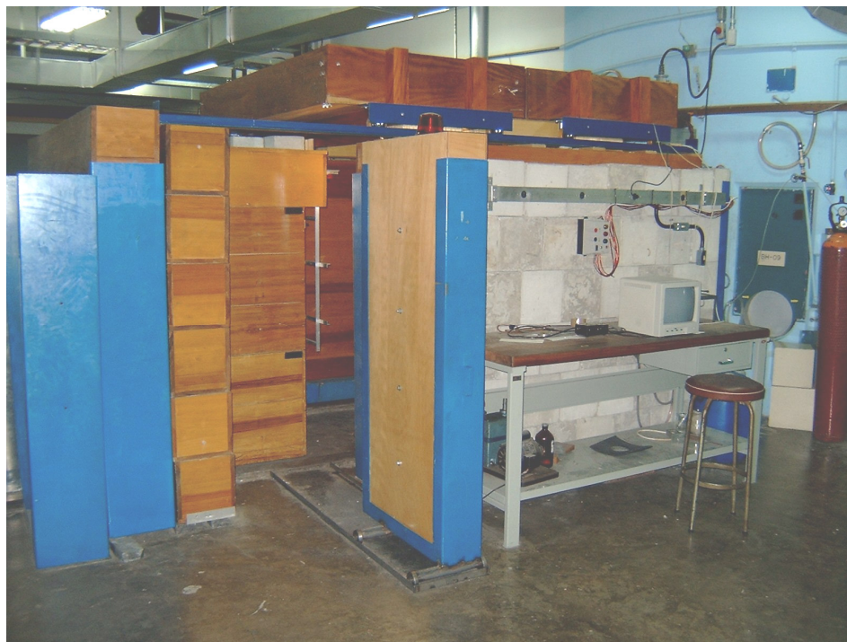
FIGURA 2.5 – Visão externa do arranjo experimental de radiografia com nêutrons.
