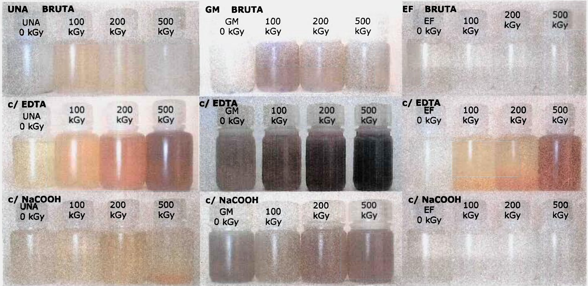
FIGURA 27 - Variação da coloração das amostras UNA, GM e EF na forma bruta, com EDTA e com NaCOOH após diferentes doses de irradiação.
