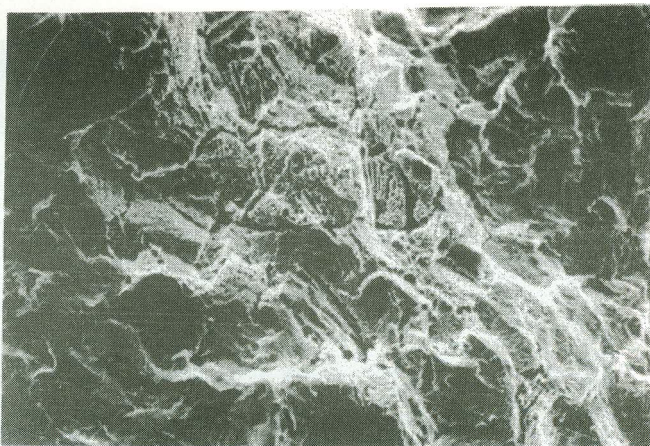
Figura 11- Fratura intergranular com microtrincas e estrias: amostra jateada (aumento: 350x).
