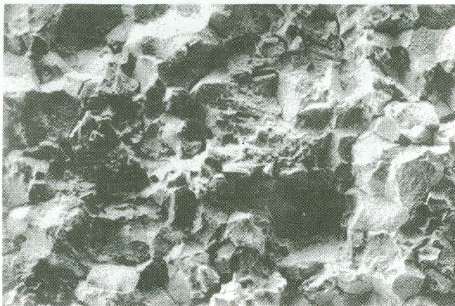
Figura 12- Fratura intergranular e presença de microtrincas: amostra jateada (aumento: 200x)
