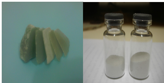
Figura 1: Quartzo Verde apresentado em pedra bruta, lâminas com faces paralelas de 2mm de espessura e grãos entre 80 \mu m e 180 \mu m.
