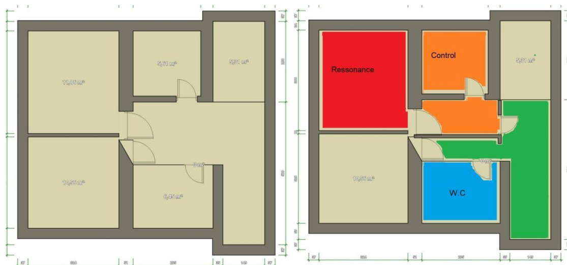
Figura 9 - Croqui sem a demarcação das zonas (A) e com a demarcação das zonas (B) do Local 2.
