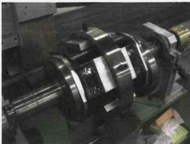
Figura A15. Ilustração do mandril facetado, com anéis pinados, compósito completamente bobinado em todas as direções projetadas, com as placas de alumínio posicionadas para garantir uniformidade na espessura, e com um anel externo de retenção.
