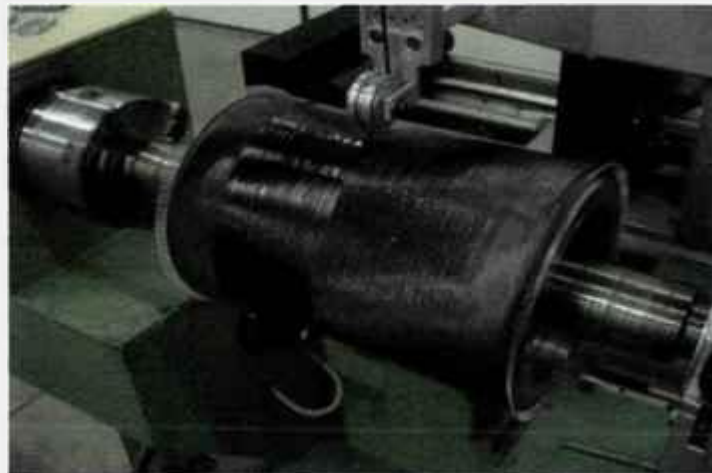
Figura 4.8. Início de bobinagem da camada circunferencial sobre as camadas helicoidais.
