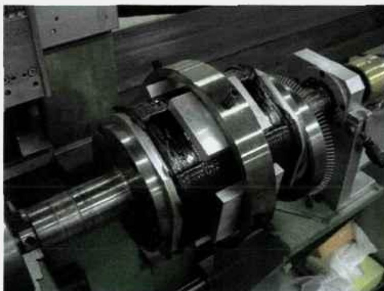
Figura 4.2 Mandril montado com placas planas e anel de contenção externo para garantir a compactação do compósito nas regiões planas.
