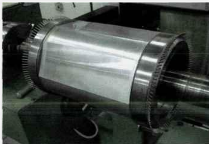
Figura 4.1 Mandril cilíndrico com cinco faces planas e anéis pinados, fabricado para servir de molde no bobinamento uni e multidirecional.
