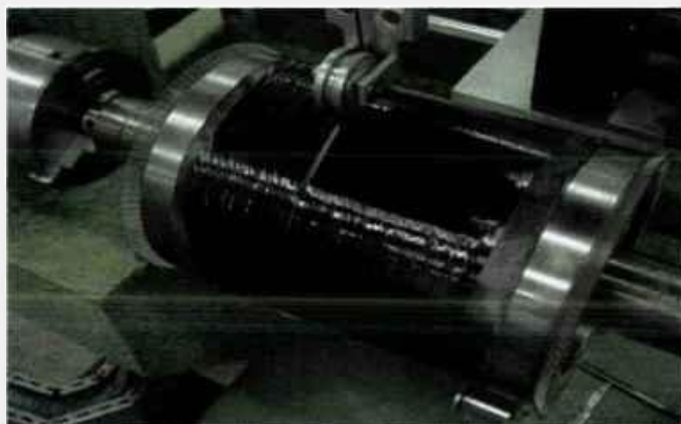
Figura 4.9. Término de bobinagem da última camada circunferencial, com os excessos de fibra das camadas helicoidais já cortadas.
