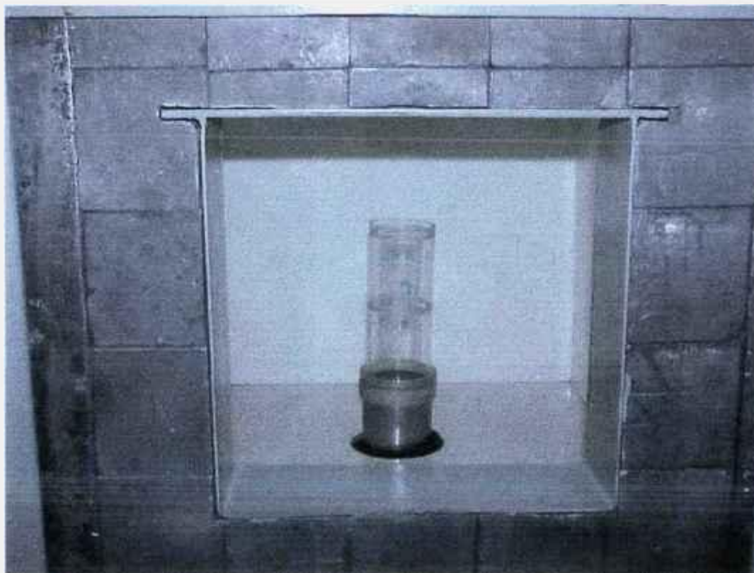
Figura 3.2 Foto do suporte para fontes do arranjo experimental com espectrômetro HPGe.
