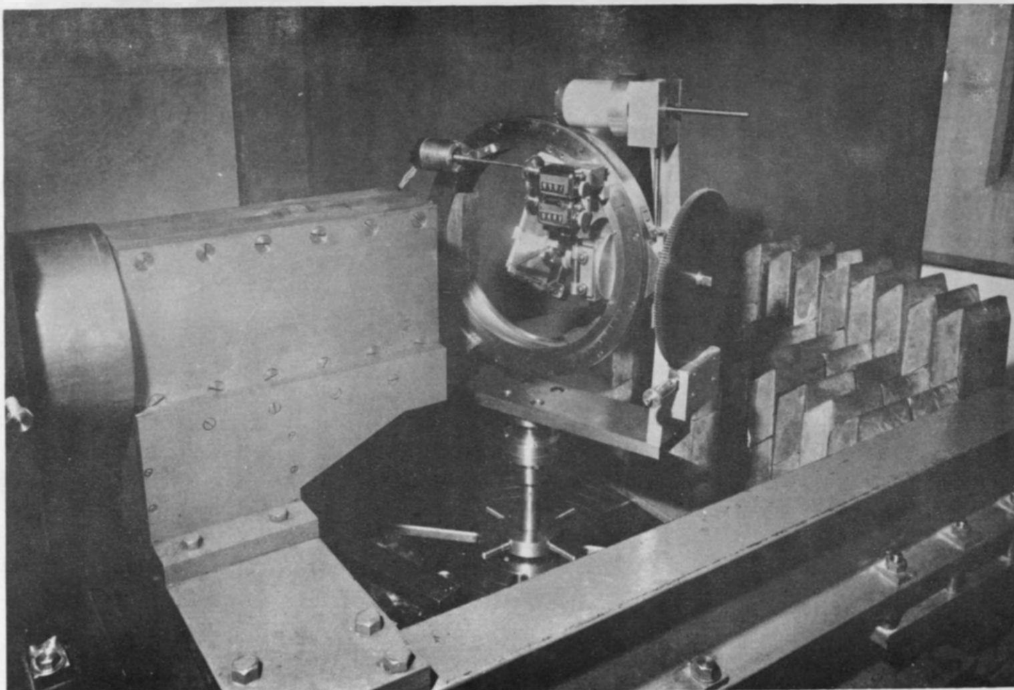
Figura II.12 - O goniostato de 5 eixos instalado no difratômetro de nêutrons do IEA.
