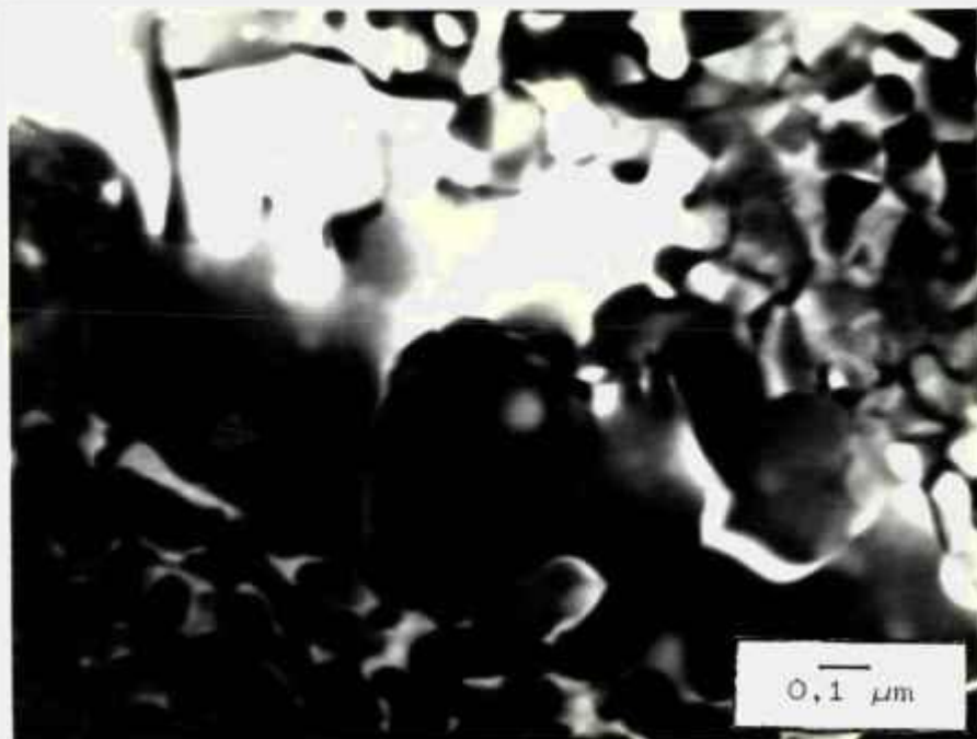
FIGURA III.23 - Micrografia eletrônica por transmissão: distribuição bimodal de DO's na amostra com 76,1 % Ni.
