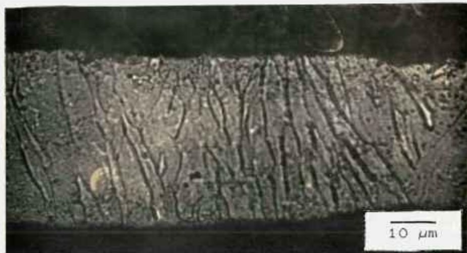
FIGURA III.2 - Fotomicrografia óptica da secção longitudinal de uma amostra da tira contendo 82,1 % at Ni.
