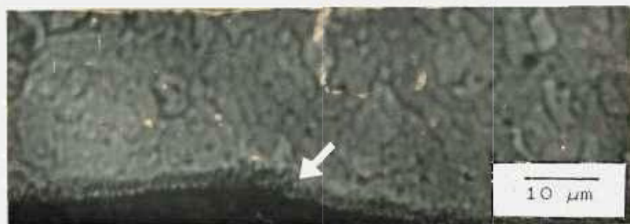
FIGURA III.3 - Fotomicrografia óptica (fora de foco) da secção longitudinal de uma amostra mostrando a zona equiaxial (seta).
