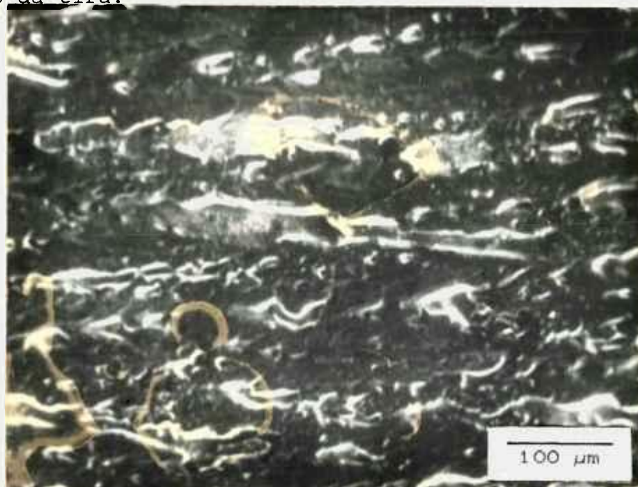
FIGURA III.5 - Micrografia eletrônica de varredura da superfície inferior de amostra da tira contendo 76,1 % at Ni.
