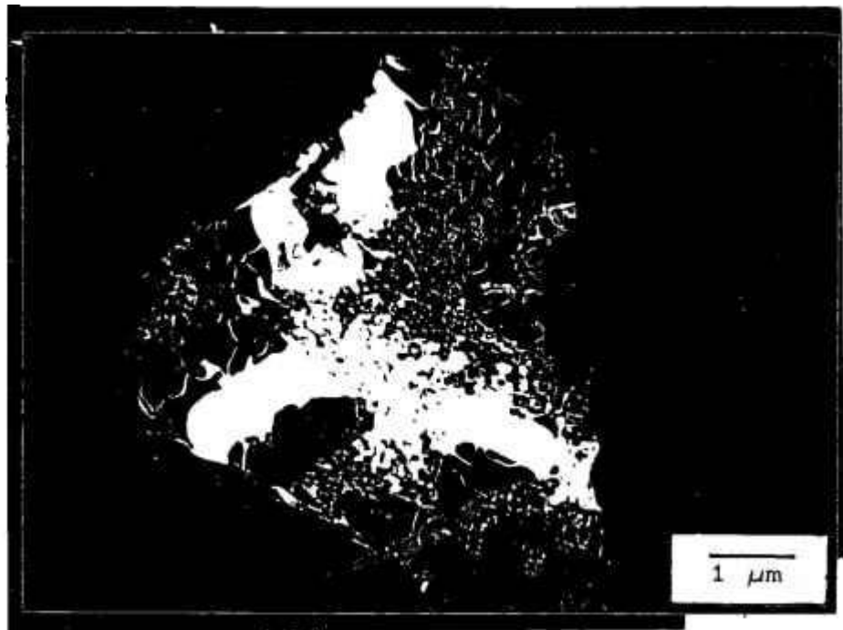
FIGURA III.26 - Micrografia eletrônica por transmissão da amostra contendo 76,8 % Ni.
