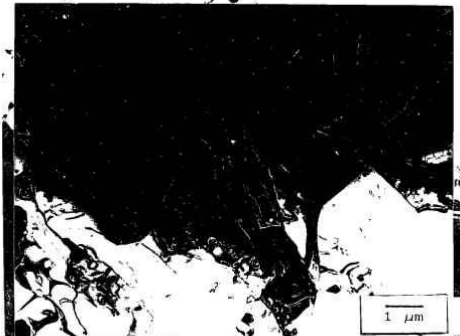
FIGURA III.16 - Micrografia eletrônica por transmissão da amostra contendo 73,0 % Ni.
