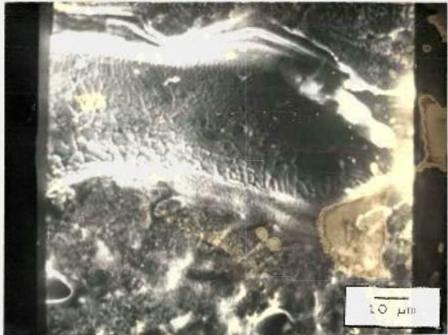
FIGURA III.6 - Micrografia eletrônica de varredura mostrando a região interior aos sulcos da face inferior de uma amostra da tira contendo 76,1 % at Ni.
