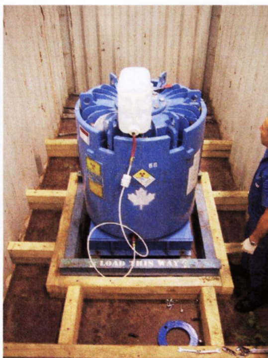
FIGURA 40 – Testes de esfregaço e fuga ( flushing test ), realizados no embalado de transporte tipo B, modelo F-168 e nas fontes seladas de ^{60}\text{Co} , respectivamente.
