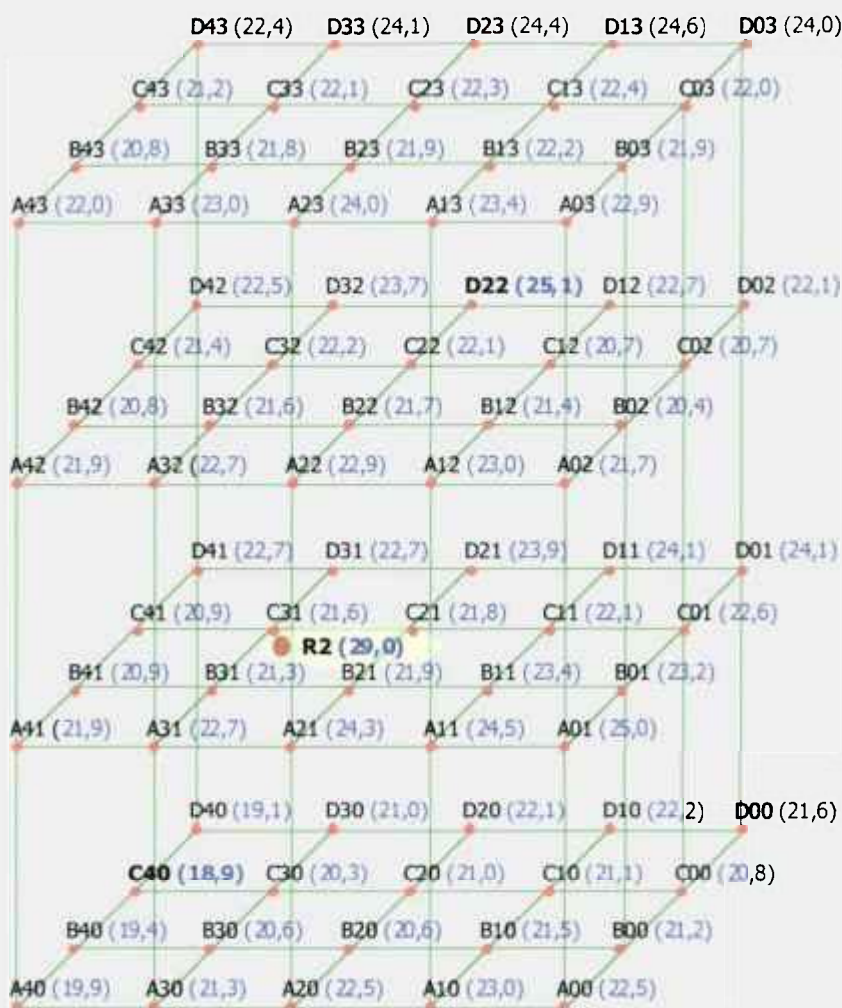
FIGURA 62 – Distribuição tridimensional das doses (kGy) nos produtos dos geradores de ^{99m}\text{Tc} , com densidade aparente de 0,09 \text{ g/cm}^3 ( 90,4 \text{ kg/m}^3 ) e fator de uniformidade de dose de 1,33. Os valores para as doses máxima, mínima e de referência encontram-se nas posições D22 (25,1 kGy), C40 (18,9 kGy) e R2 (29,0 kGy), respectivamente.
