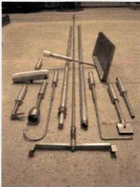
FIGURA 43 – Ferramentas reguláveis, especialmente confeccionadas para o manuseio e instalação das fontes seladas de ^{60}\text{Co} , nos magazines e nos racks de fontes.
