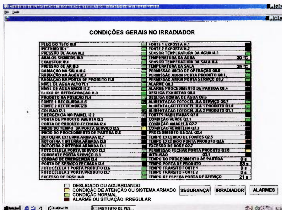
FIGURA 61 – Tela do sistema de segurança e intertravamento no microcomputador, com as condições gerais do irradiador multipropósito, do IPEN-CNEN/SP.
