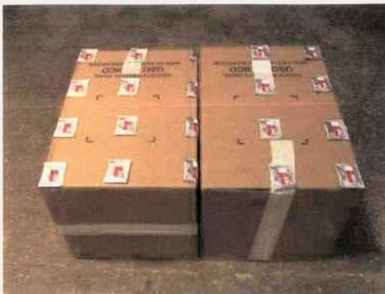
FIGURA 44 – Posicionamento dos 20 dosímetros de rotina tipo Red Perspex 4034 (lote GD) por plano, utilizados no mapeamento de dose nos produtos (tampas e mangueiras poliméricas dos geradores de ^{99m}\text{Tc} ).
