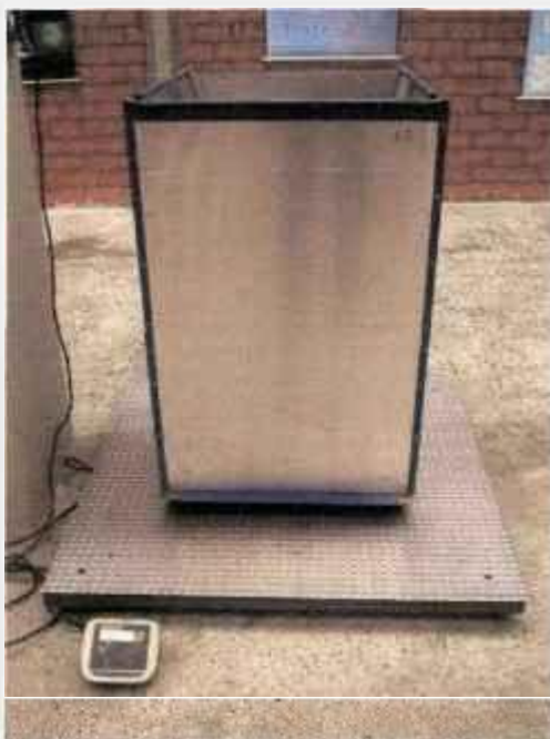
FIGURA 47 – Balança digital industrial, marca DIGIMED, modelo KN1-P12/12k, com capacidade máxima de 1.000 kg, utilizada na determinação das densidades aparentes dos produtos.
