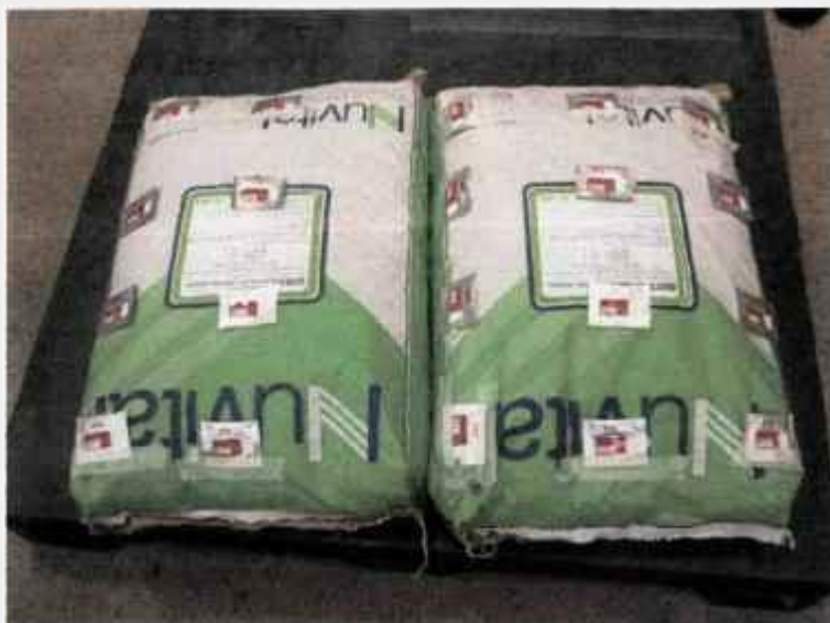
FIGURA 52 – Posicionamento dos 20 dosímetros de rotina tipo Red Perspex 4034 (lote GD) por plano, utilizados no mapeamento de dose nos produtos (ração animal para biotério).
