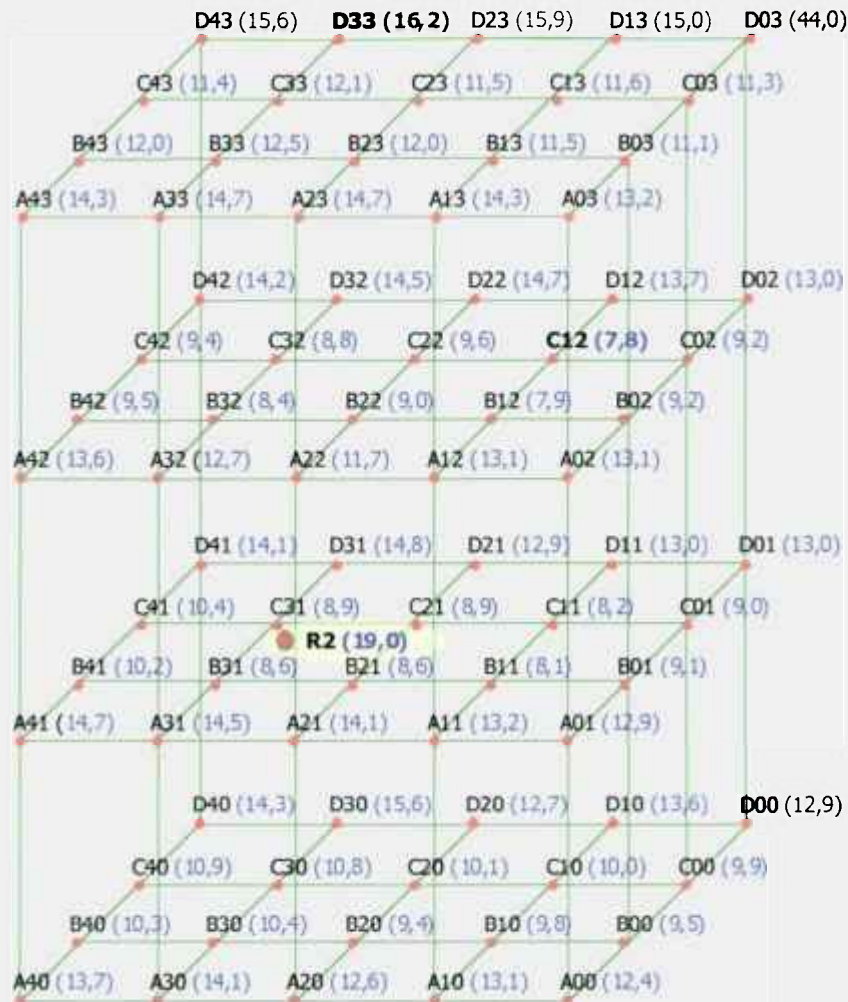
FIGURA 63 – Distribuição tridimensional das doses (kGy) nos produtos para biotério (ração animal), com densidade aparente de 0,49 \text{ g/cm}^3 ( 487 \text{ kg/m}^3 ) e fator de uniformidade de dose de 2,08. Os valores para as doses máxima, mínima e de referência encontram-se nas posições D33 (16,2 kGy), C12 (7,8 kGy) e R2 (19,0 kGy), respectivamente.
