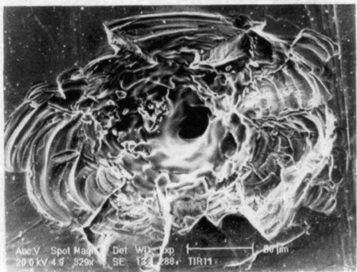
Figura 14b: cavidade obtida na amostra de cristal YLF nas seguintes condições: E = 0,94 mJ, frequência = 10 Hz e t = 5 s
