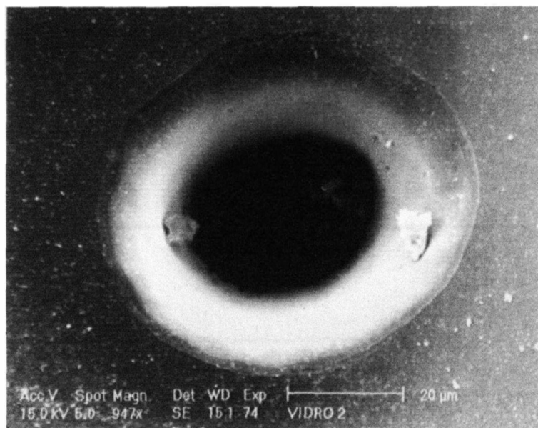
Figura 13b: Cavidade em vidro de béquer obtida nas seguintes condições: E = 4,0 mJ, frequência de 20 Hz e tempo de ablação 5 s (total de tiros = 100).
