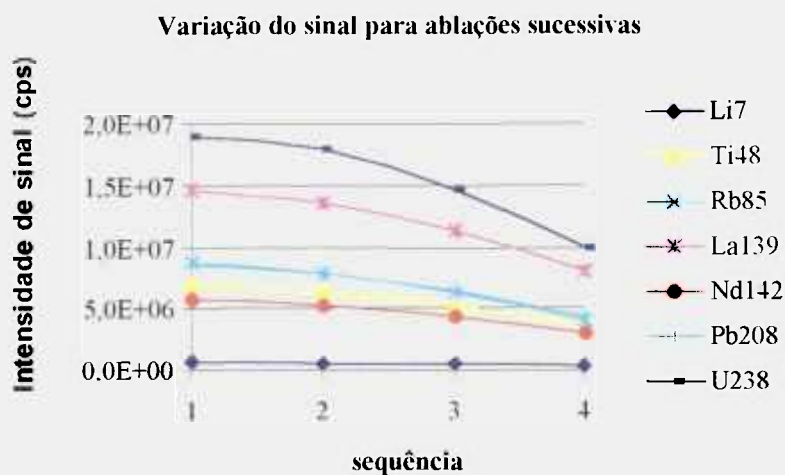
Gráfico 8a: comportamento do sinal para 4 ablações sucessivas na mesma área. Estes dados correspondem a ablação do material de referência NIST612.
