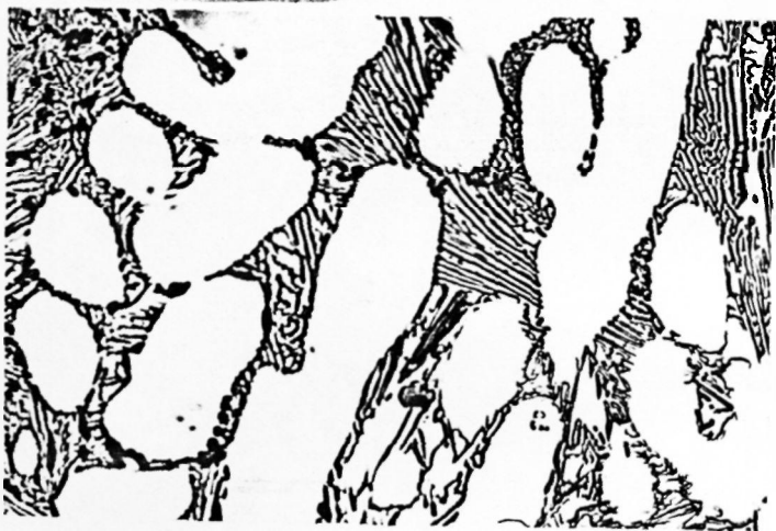
Fig. 38 - Microestrutura da Liga Al-11Zn, hipoeutética. Dendritas de (Al) e eutético interdendrítico. Polimento eletrolítico. Aumento: 800X.
