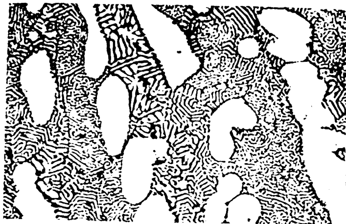
Fig. 9 - Microestrutura da Liga Zn-2,0%Mg hipoeutética. Estrutura dendrítica de (Zn) e eutético (Zn)-MgZn 2 interdendrítico. Ataque: Nital. Aumento: 1.500X.
