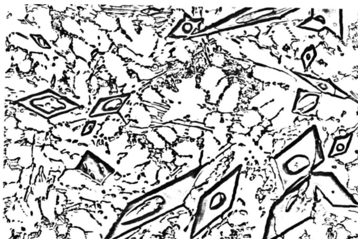
Fig. 41 - Microestrutura da Liga hipereutética, Al-20%U, apresentando a fase UAl_4 em forma de losango, dendritas de (Al) e eutético interdendrítico. Polimento eletrolítico. Aumento: 750X.
