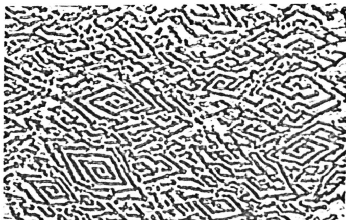
Fig. 43 - Eutético (Al)- UAl_4 , apresentando espirais em forma de losango. Liga Al-19%U. Ataque: HF. Aumento: 1.250X.
