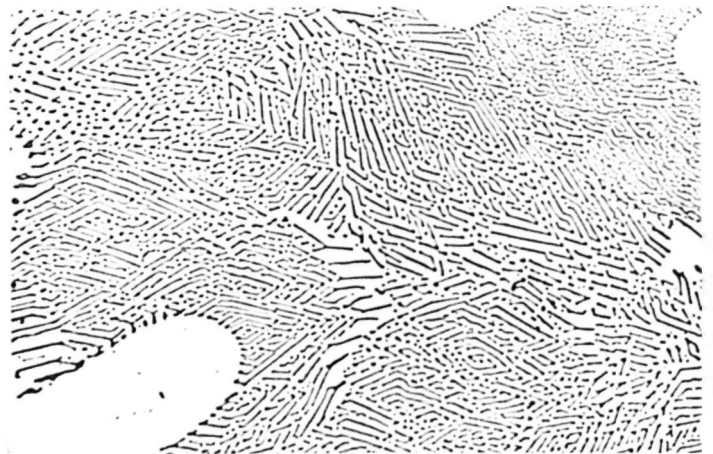
Fig. 54 - Secção transversal à direção de crescimento. Eutético (Al)- UAl_4 e dendritas da fase (Al). Estrutura obtida em solidificação unidirecional. V = 400 mm/h. Liga Al-13,10% U. Ataque: HF (1%). Aumento: 750X.
