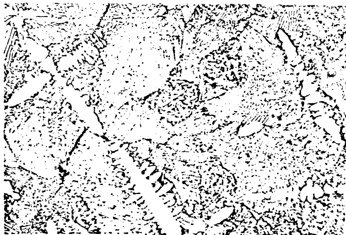
Fig. 11 - Microestrutura da Liga Zn-2,8%Mg, hipoeutética. Detalhe região apresentada na fig. 10, com dendritas de fase (Zn) e eutético (Zn)-MgZn 2 . Ataque: Nital. Aumento: 750X.
