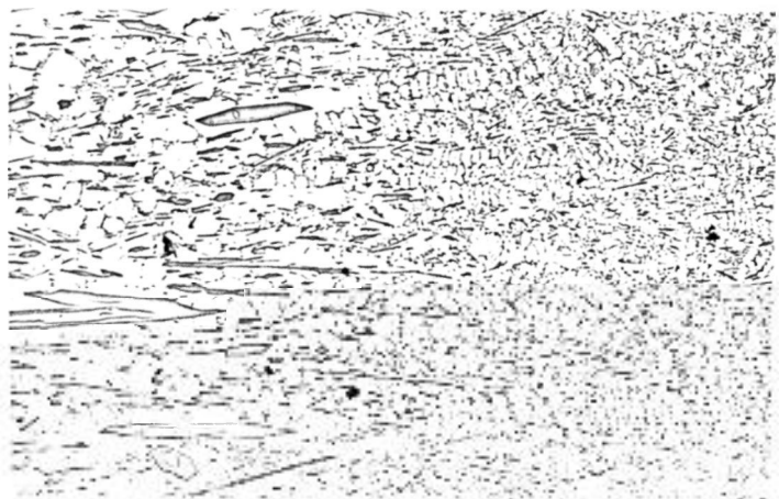
Fig. 78 - Mudança de estrutura da Liga hipereutética Al-24%Th ao ser aumentada a velocidade de crescimento, em solidificação unidirecional. Secção longitudinal. Velocidade anterior a mudança: V = 20 mm/h. Ataque HF (1%). Aumento: 50X. Estrutura com proeutético ThAl 3 passa a estrutura com dendritas de (Al).
