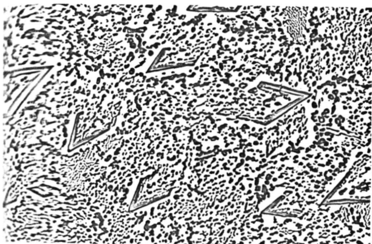
Fig. 45 - Proeutéticos UAl_4 em secção transversal. Liga Al-16%Zn solidificada unidirecionalmente. V = 40 mm/h. Polimento eletrolítico. Aumento: 150X.
