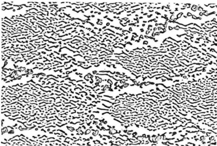
Fig. 51 - Seção transversal de estrutura eutética (Al)- UAl_4 , em solidificação unidirecional. Células eutéticas com plaquetas e glóbulos de UAl_4 em matriz de (Al) V = 40 \text{ mm/h} . Liga Al-13,8%U. Ataque: HF (1%). Aumento: 300X.
