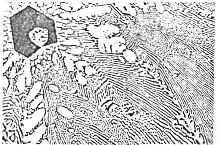
Fig. 63 - Detalhe da região apresentada na Fig. anterior, mostrando o proeutético ThAl 3 envolvido por dendrita de (Al) e o eutético. Ataque: HF (1%). Aumento: 900X.
