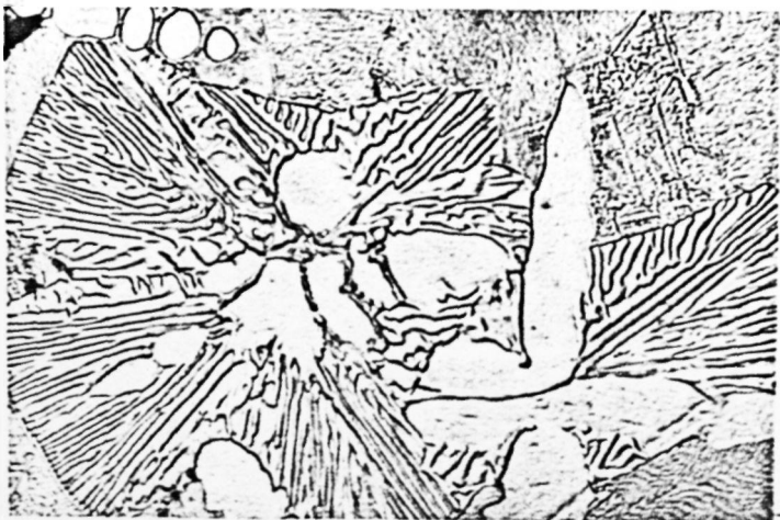
Fig. 14 - Outro aspecto semelhante ao apresentado na Fig. 13. Eutético (Zn)-MgZn 2 dendritas de (Zn) e eutético (Zn)-Mg 2 Zn 11 . Liga Zn-2,8%Mg. Ataque: Nital. Aumento: 1.200X.
