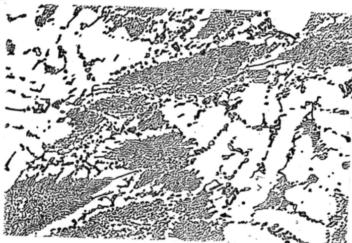
Fig. 44 - Secção transversal de lingote da Liga Al-11%Zn, hipoeutética, solidificada unidirecionalmente. Dendritas de (Al) e eutético interdendritico. V = 40 mm/h. Aumento: 125X.
