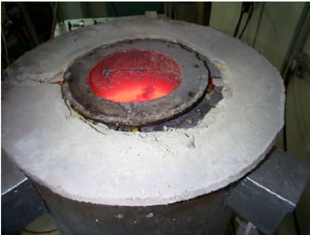
Figura 3. Carbonato de sódio fundido a 1.000 °C.
