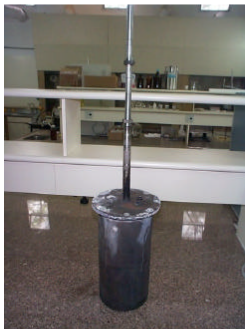
Figura 2. Vaso do reator e lança para introdução do resíduo.
