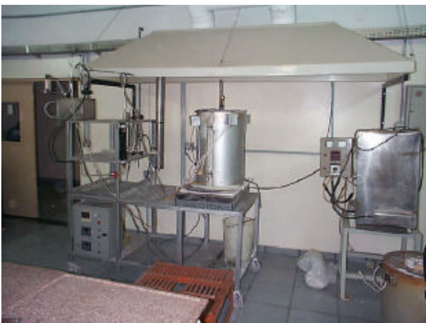
Figura 4. Montagem do equipamento para oxidação em sais fundidos.
