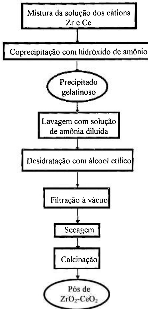
Figura 3.2: Fluxograma das etapas de preparação pela técnica de coprecipitação.
