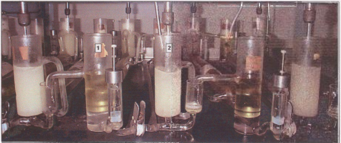
FIGURA 4.4 – Foto da vista lateral (AA) da bateria de misturadores-decantadores em funcionamento.
