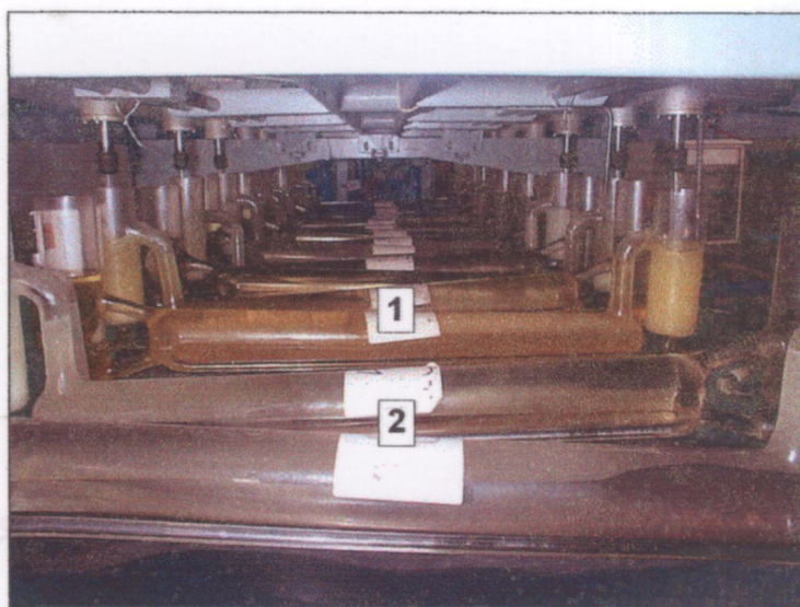
FIGURA A.4 – Câmaras de decantação. No detalhe: tratamento da fase orgânica utilizada (1), pré-equilíbrio da fase orgânica (2).
