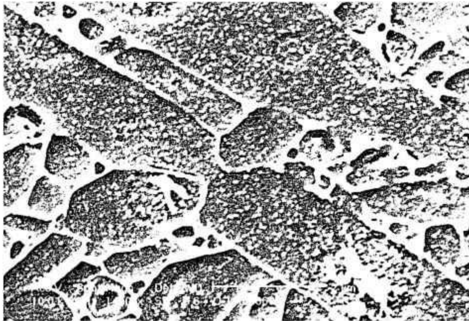
Figura II-11 - Micrografia mostrando diferentes exemplos de obstrução estérica que impedem o crescimento de grãos do \beta -Si 3 N 4
