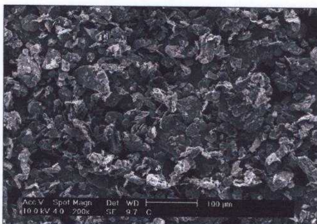
FIGURA 3.8 - Macrografia obtida por MEV, mostrando o aspecto morfológico tipo flocos ("flakes") do pó de grafite.
