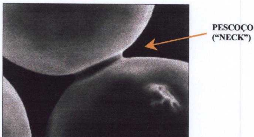
FIGURA 2.9 – Formação de pescoço ("neck"), em consequência da ligação inicial entre as partículas [2].
