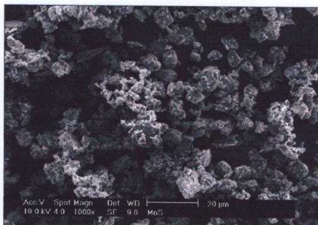
FIGURA 3.10 - Macrografia obtida por MEV, mostrando o aspecto morfológico aglomerado do pó de sulfeto de manganês.
