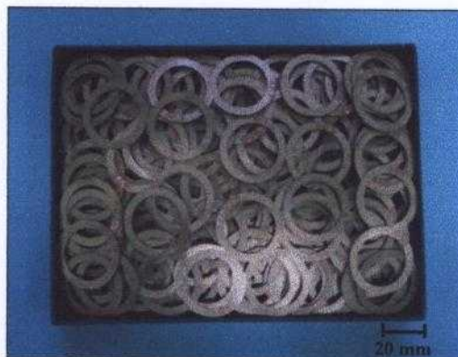
FIGURA 3.17 - Detalhe dos anéis de cobre compactados, para serem incorporados nas ligas por infiltração.
