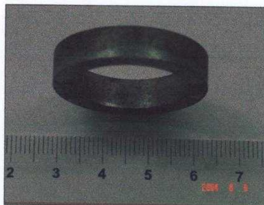
FIGURA 4.13 – Foto mostrando um anel com uma região mais escura indicando a presença de cobre e outra mais clara indicando a ausência do elemento.
