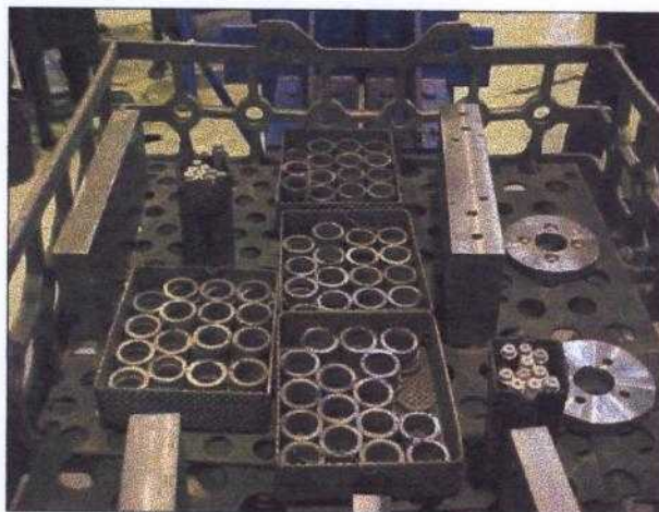
FIGURA 3.23 - Arranjo dos insertos posicionados na bandeja após tratamento térmico.
