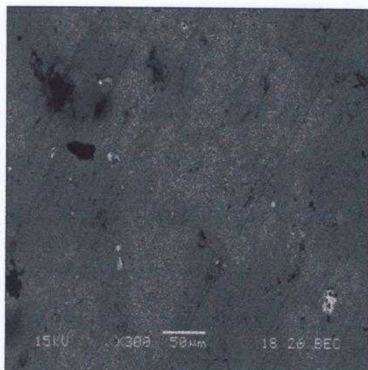
FIGURA 4.69 – Micrografia eletrônica de varredura mostrando o aspecto geral da superfície ensaiada do corpo de prova da liga 5 após o teste de desgaste.
