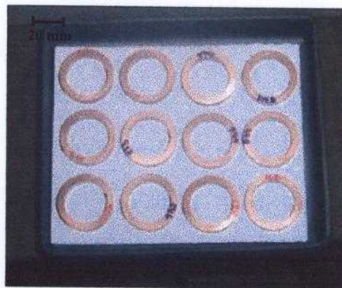
FIGURA 3.20 - Aspecto geral do arranjo físico das peças para sinterização.
