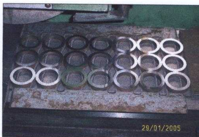
FIGURA 3.25 - Inserts durante a operação de retificação das faces.
