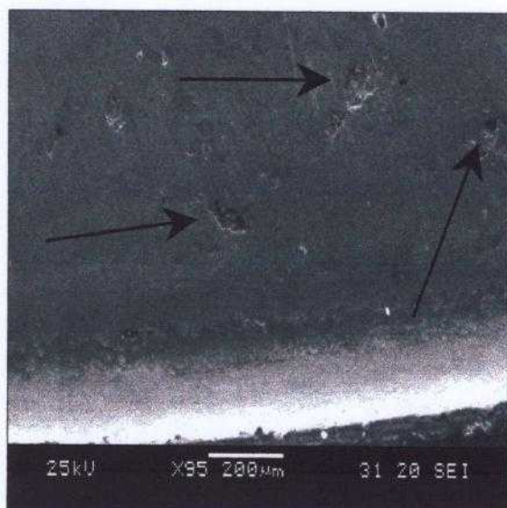
FIGURA 4.9 – Micrografia eletrônica de varredura mostrando partículas ou porções de material destacadas da região de contato do assento de válvula (superfície do assento).
