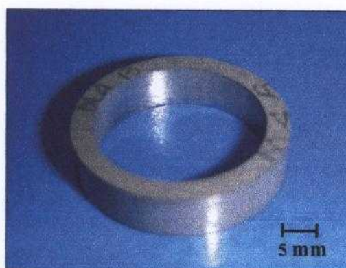
FIGURA 3.15 - Aspecto geral de um inserto após compactação (compactado à verde).
