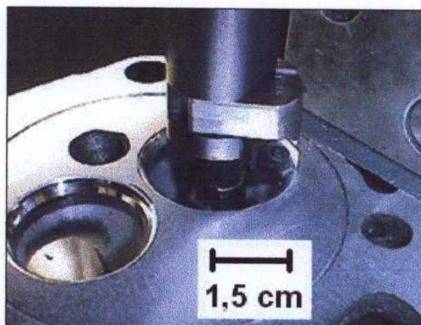
FIGURA 2.14 – Detalhe do assento de válvula sendo usinado no bloco do motor.
