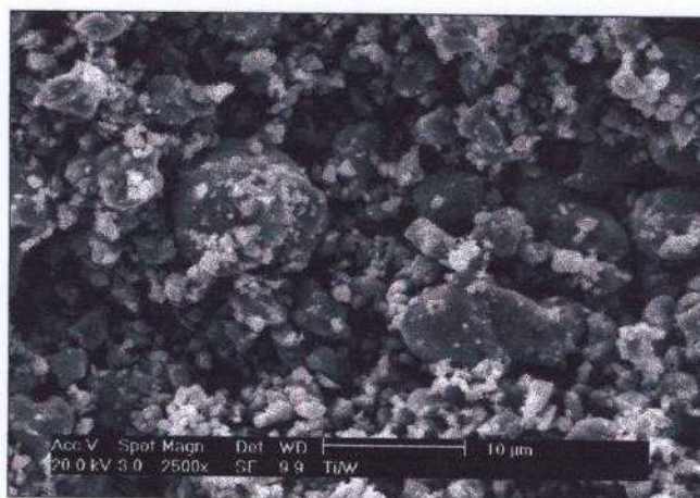
FIGURA 3.12 - Macrografia obtida por MEV, mostrando o aspecto morfológico aglomerado do pó de carboneto de Ti/W.
