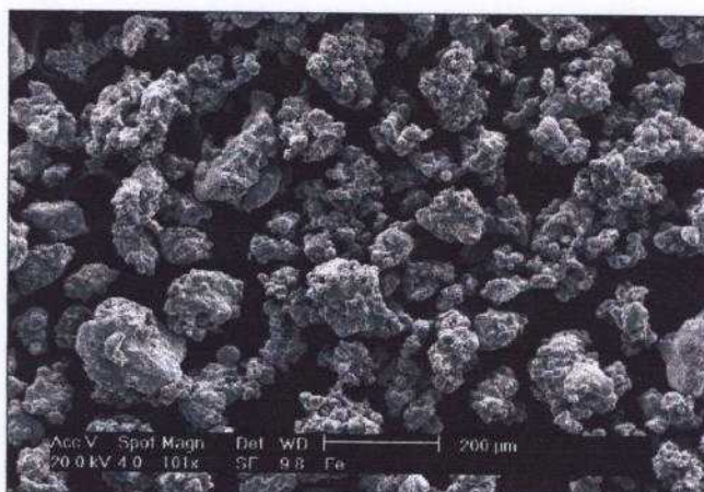
FIGURA 3.4 - Macrografia obtida por MEV, mostrando o aspecto morfológico do pó de ferro puro.
