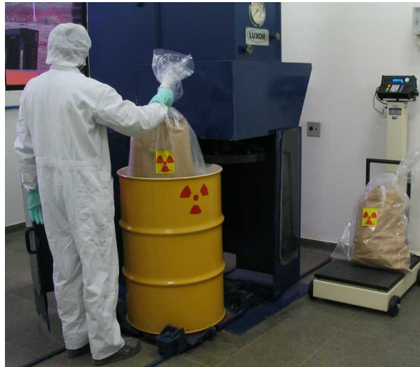
Figura 7. Vista geral da unidade de compactação
