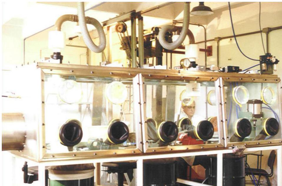
Figura 6. Caixa com luvas utilizada para desmontagem de pára-raios radioativos
