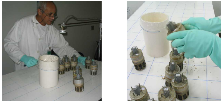
Figura 11. Desmontagem de detetores de fumaça
