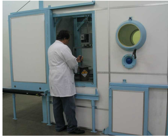
Figura 9. Vista geral da cela blindada de desmantelamento de fontes
