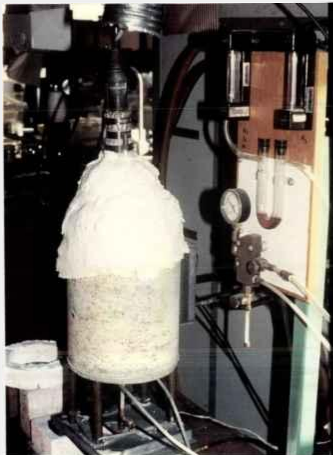
Figura 3.2 - (a) Foto do forno de indução utilizado na síntese carbotérmica
