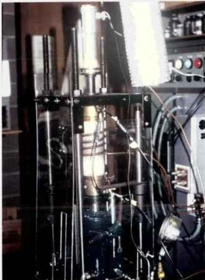
Figura 3.3 - Prensa uniaxial a quente para densificação do composto \text{Al}_2\text{O}_3\text{-SiC-ZrO}_2
