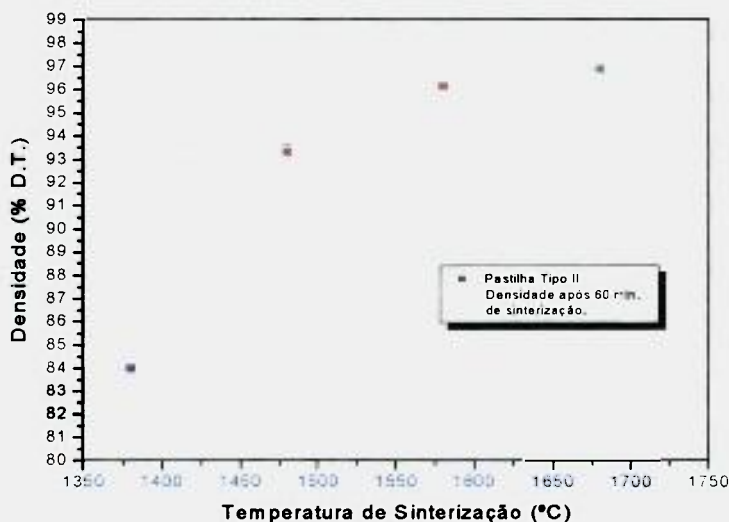
Figura 4.16: Influência da temperatura de sinterização na densidade final das pastilhas de alumina pura tipo II, sinterizadas ao ar por 60 minutos.
