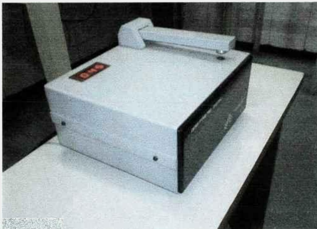
FIGURA 4.3 - Densitômetro digital MRA – Ind. de Equipamentos Eletrônicos, construído especialmente para medidas de densidade óptica de vidros com espessuras entre 2,5 e 3,5 mm.
