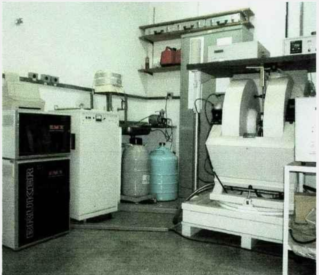
FIGURA 4.6 - Espectrômetro BRUKER EMX com uma cavidade retangular padrão (ER4102 ST), Instituto de Física/Universidade de São Paulo.
