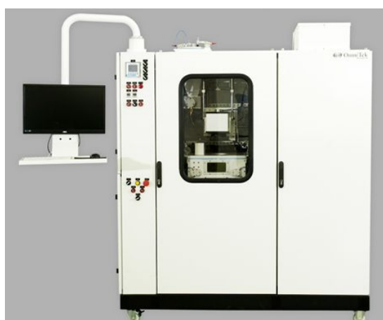
Figure 3: Equipamento OminiSint-160 de fusão seletiva a laser da empresa Ominitek.
