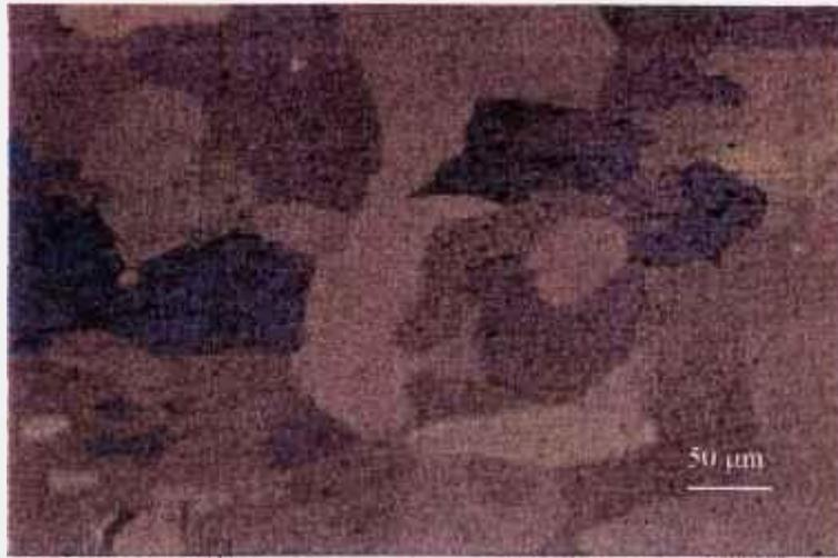
Figura 6.1.1: Micrografia do alumínio obtida por microscopia óptica sob luz polarizada. Ataque: HF a 0,2%.
