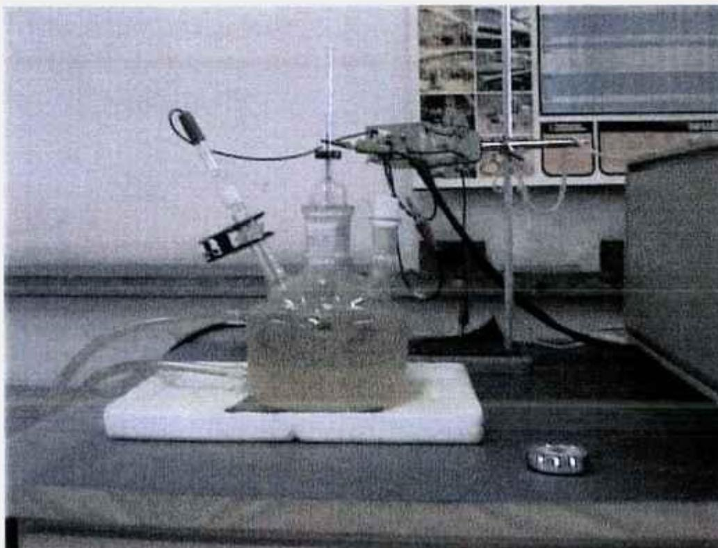
Figura 5.1.1.1: Célula eletroquímica encamisada de vidro borossilicato. (Detalhes no Apêndice 1).
