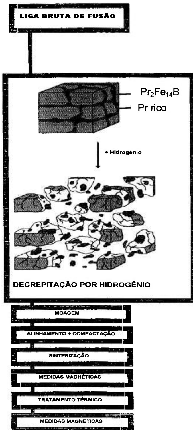
Figura 8 - Fluxograma de obtenção dos ímãs de PrFeB via processo HD.
