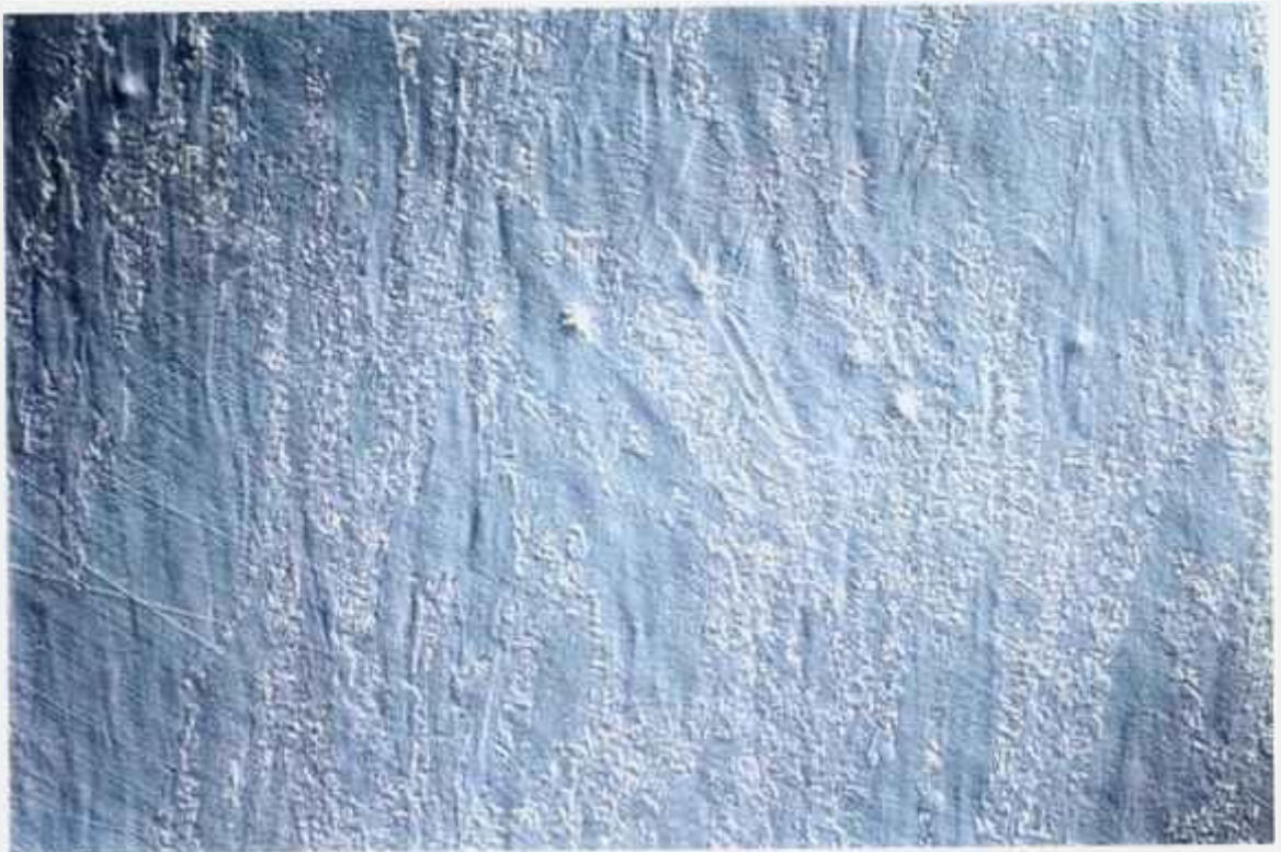
Figura 4.9 Micrografia ótica da barra forjada da liga CrNiCo mostrando recristalização parcial, aumento: 125X, ataque: Glicerégia. (6/0484)
