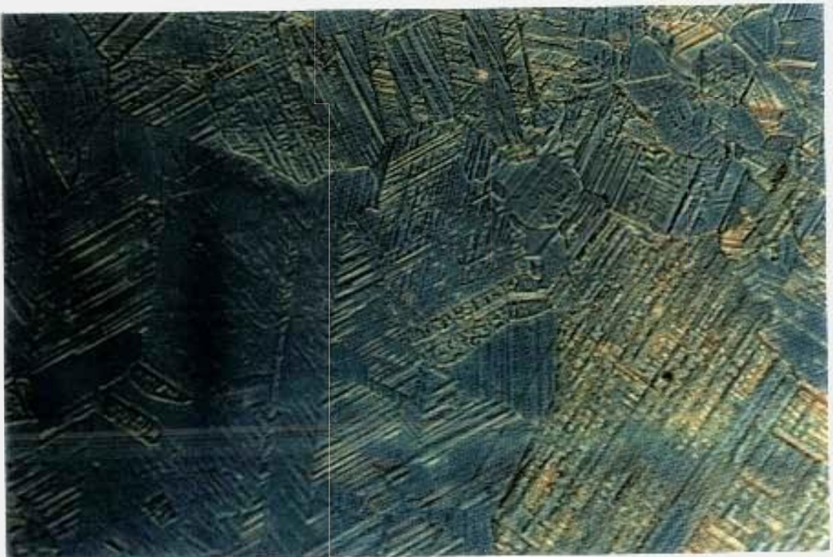
Figura 5.37 Liga CrNi, AM10, solubilizada a 1050 °C e imersa em N 2 líquido por 5 minutos, ataque: Glicerégia; aumento: 220X (7/16493)
