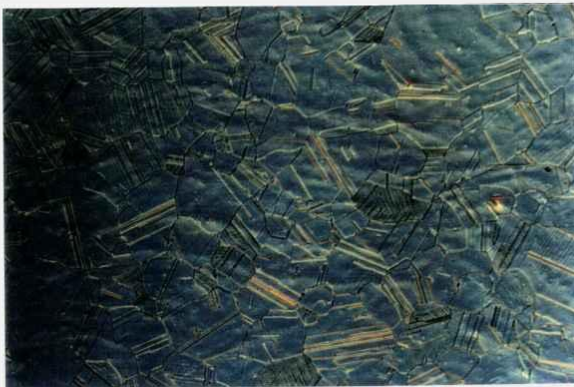
Figura 5.28 Liga CrNiCo, AM20A, solubilizada a 1050 °C por 1h e resfriada em água, ataque: Glicerégia; aumento: 55X (4/16493)
