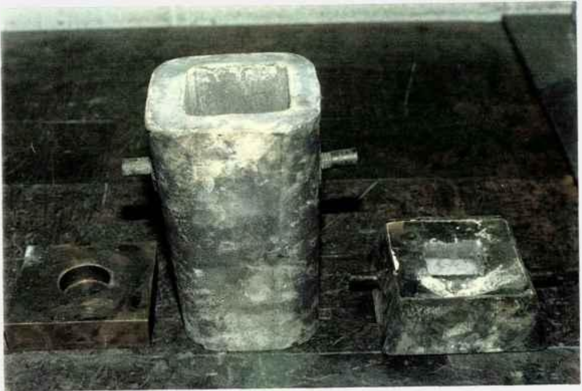
Figura 4.2 Lingoteira de ferro fundido (centro) com base de cobre (esquerda) e cabeça quente (direita).
