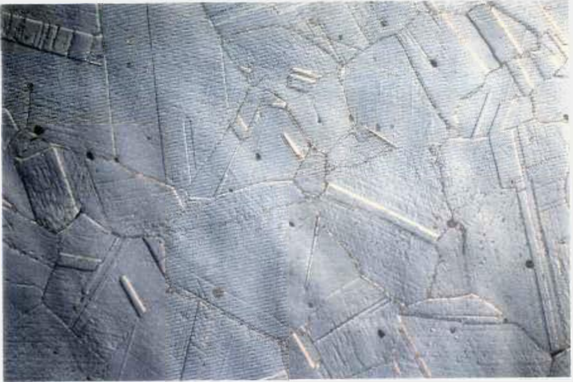
Figura 5.40 Liga CrNiCo, AM25, após 3 ciclos a 680 °C + 3 ciclos a 630 °C, mostrando precipitação de carboneto de cromo em contorno de grão, ataque: Glicerégia; aumento: 500X (24/0484)
