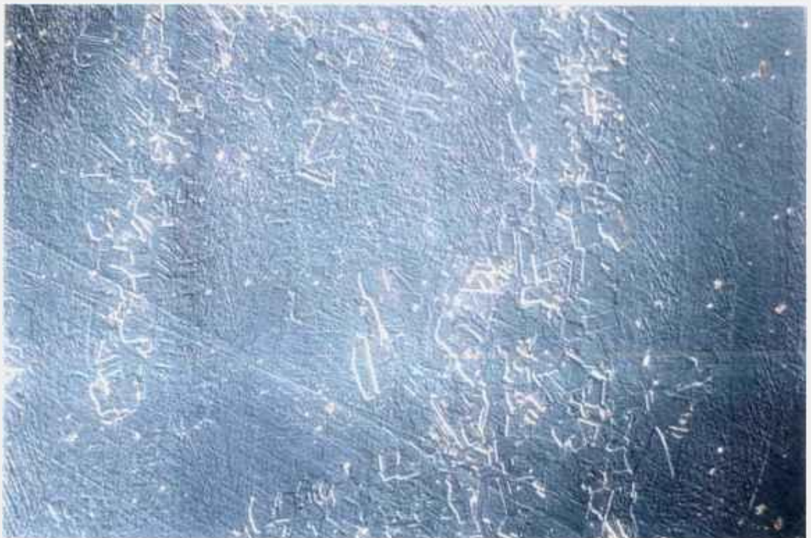
Figura 4.10 Micrografia da barra da liga CrNiCo tirada a meio raio, aumento: 500X, ataque: Glicerégia. (6/0484)
