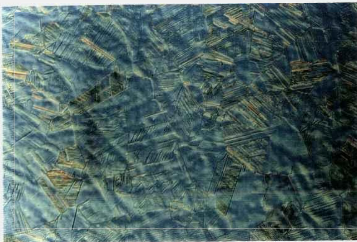
Figura 5.29 Liga CrNiCo, AM20, solubilizada e imersa em N 2 líquido por 5 minutos, ataque: Glicerégia; aumento: 55X (2/16493)
