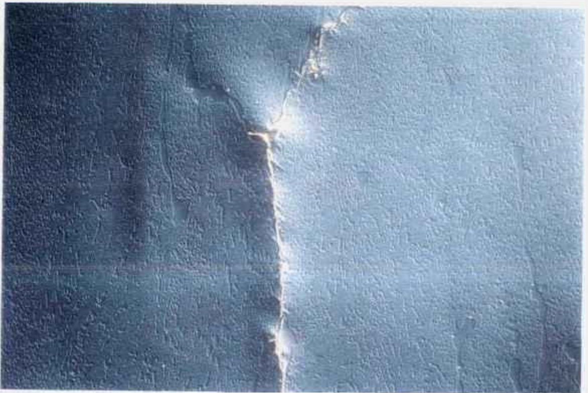
Figura 4.12 Ídem acima, mostrando detalhes da região da trinca, aumento: 250X (10/0484)
