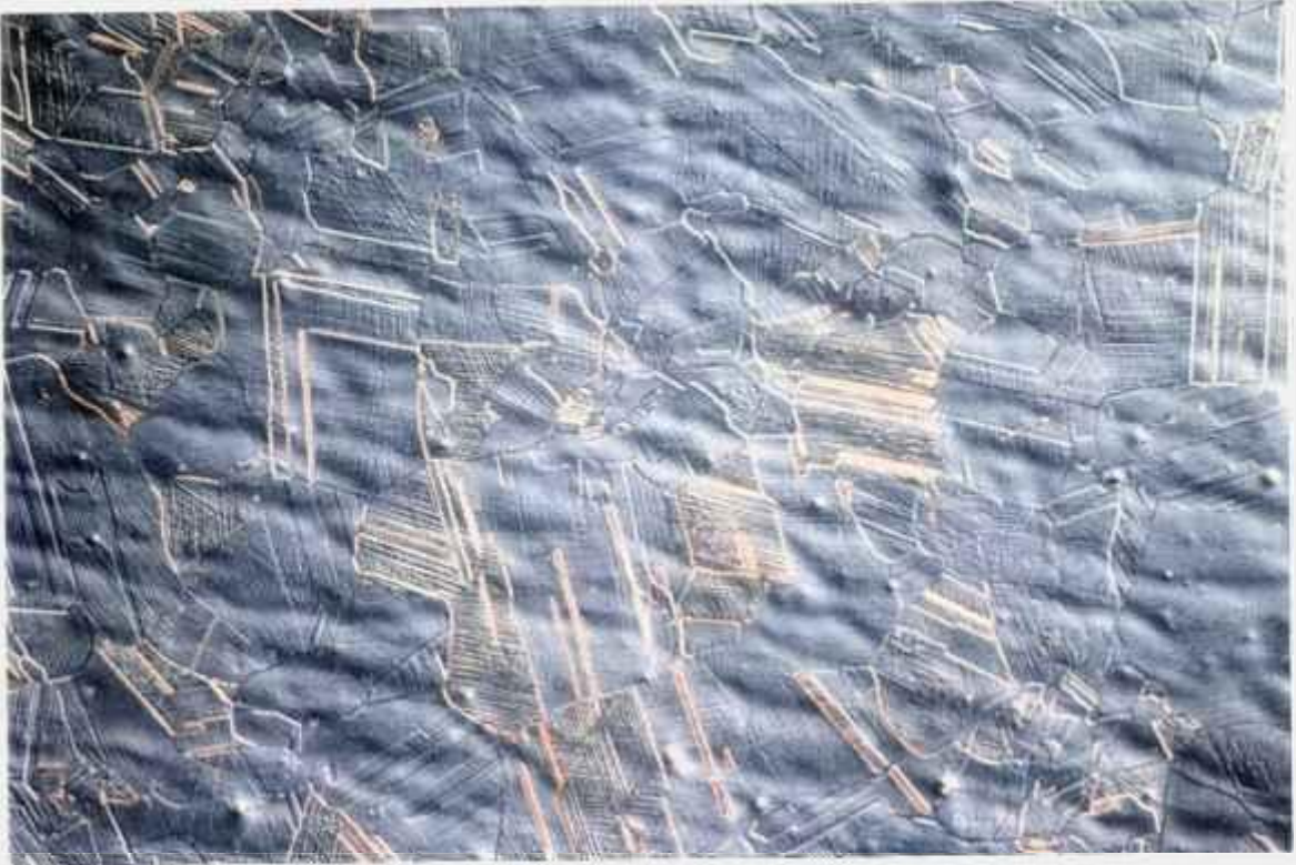
Figura 5.34 Liga CrNiCo (AM22), pré-deformada 4 %, ataque: Glicerégia; aumento: 125X (21/0484)
