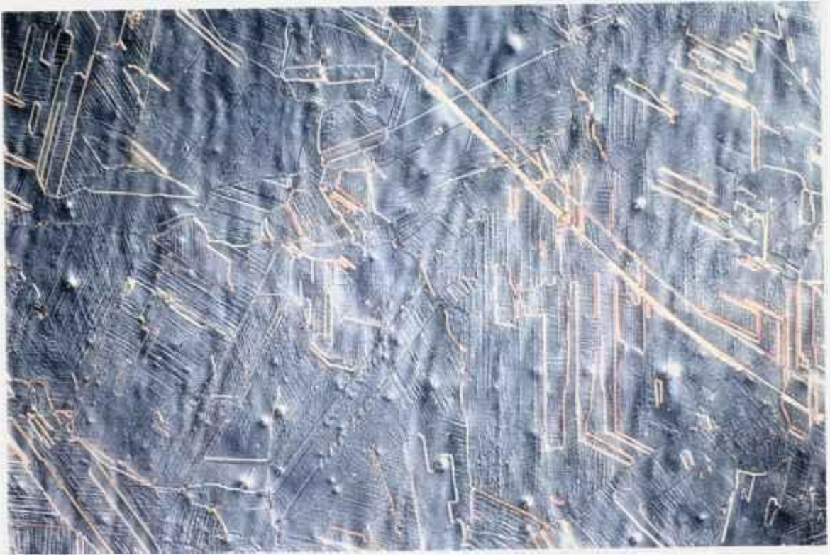
Figura 5.36 Liga CrNiCo (AM241), após 6 ciclos a 600 °C, ataque :Glicerégia; aumento: 125X (19/0484)
