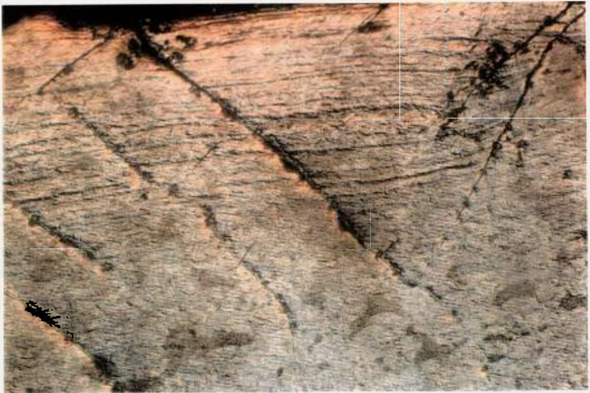
Figura 4.17 Liga CrNi após redução de área por laminação superior a 50 % de redução de área apresentado trincas, aumento: 64X; ataque: Glicerégia. (5/0484)
