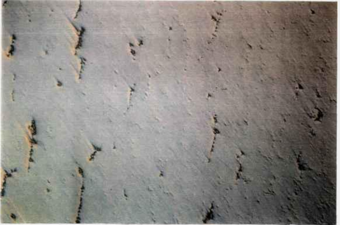
Figura 4.11 Micrografia da barra da liga CrNiCoTi mostrando microtrincas, aumento: 64X. (9/0484)
