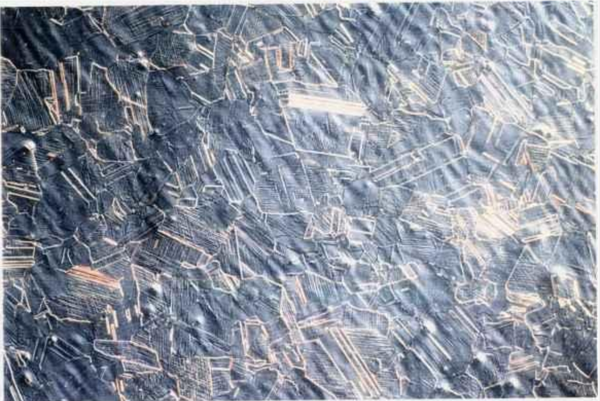
Figura 5.35 Liga CrNiCo (AM21), após 5 ciclos a 450 °C, ataque: Glicerégia; aumento: 125X (22/0484)
