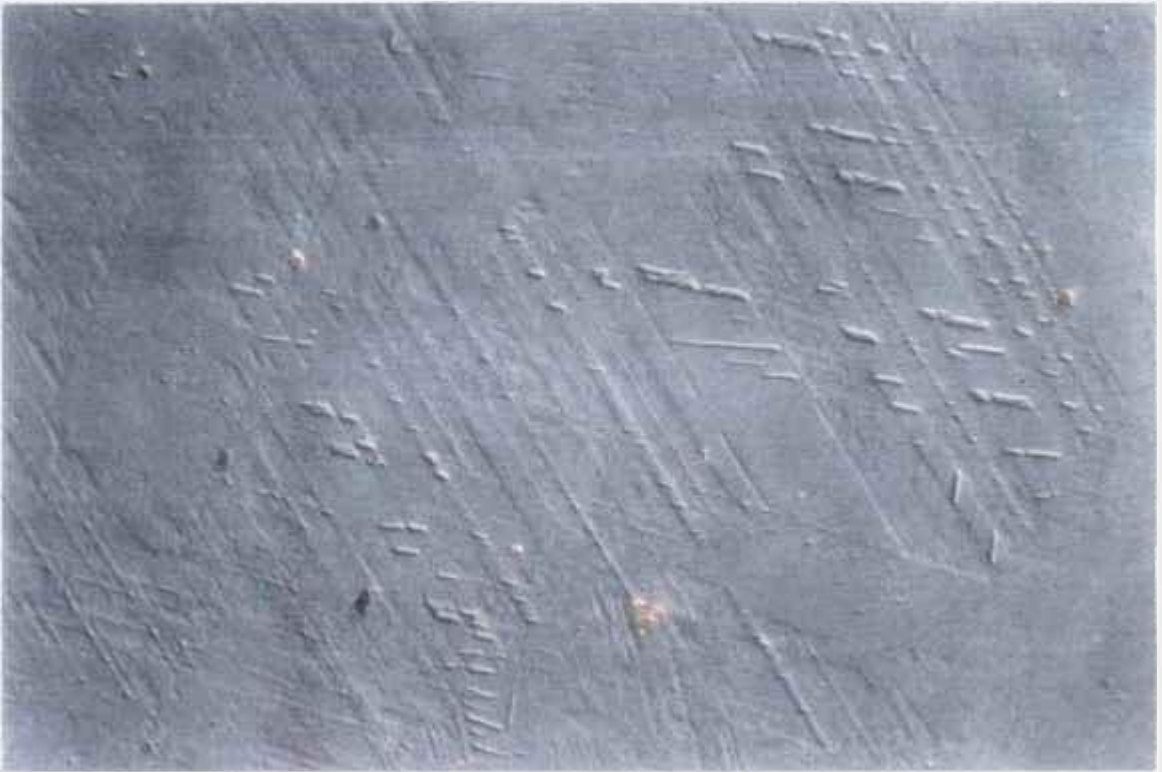
Figura 5.38 Liga CrNi, AM16, após 6 ciclos a 600 °C, mostrando precipitação de martensita \alpha' , ataque: Glicerégia; aumento: 1000X (3/0445)
