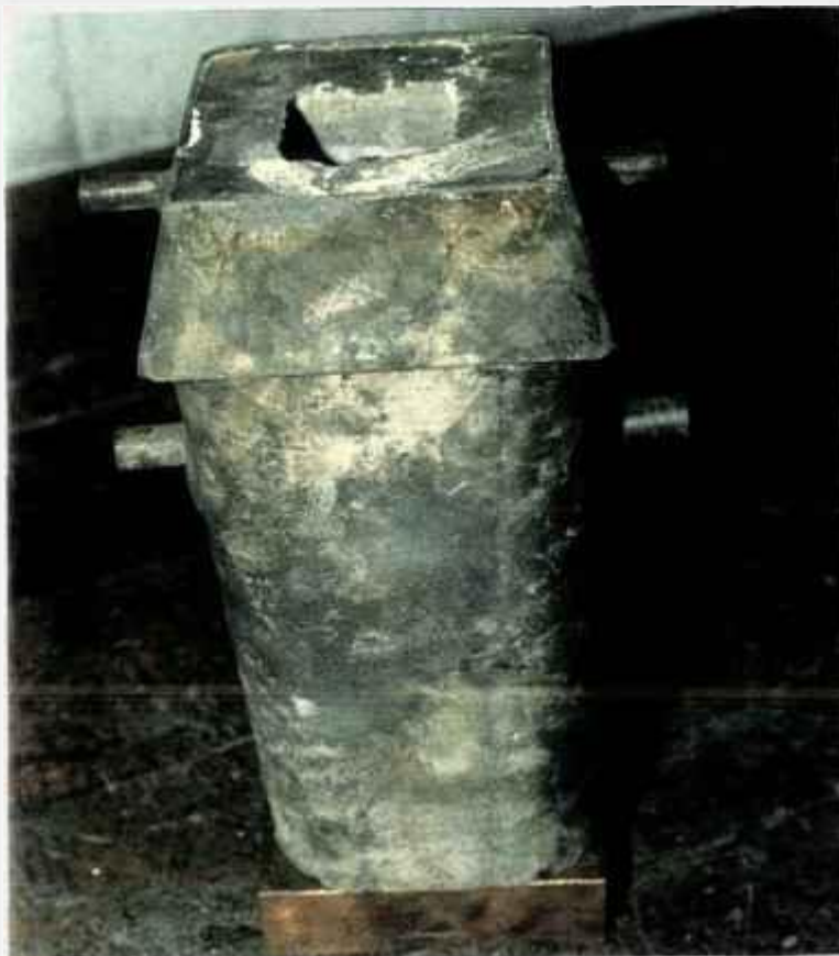
Figura 4.3 Lingoteira montada, pronta para ser colocada na câmara de fusão.
