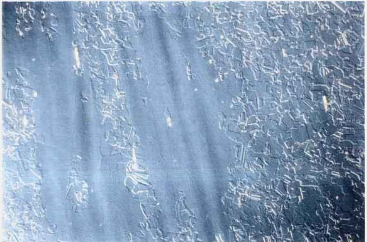
Figura 4.8 Micrografia da barra da liga CrNi tirada a meio raio, aumento: 500X, ataque: Glicerégia. (13/0484)
