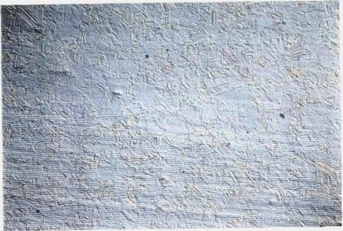
Figura 4.13. Seção transversal do fio de diâmetro 5,00 mm da liga CrNi recozida a 1050 °C por 40 min., aumento: 100X; ataque: Glicerégia. (18/445)
