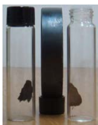
Figura 1. Compósitos ZM39 e ZM3D sob a ação de um campo magnético de um ímã.
